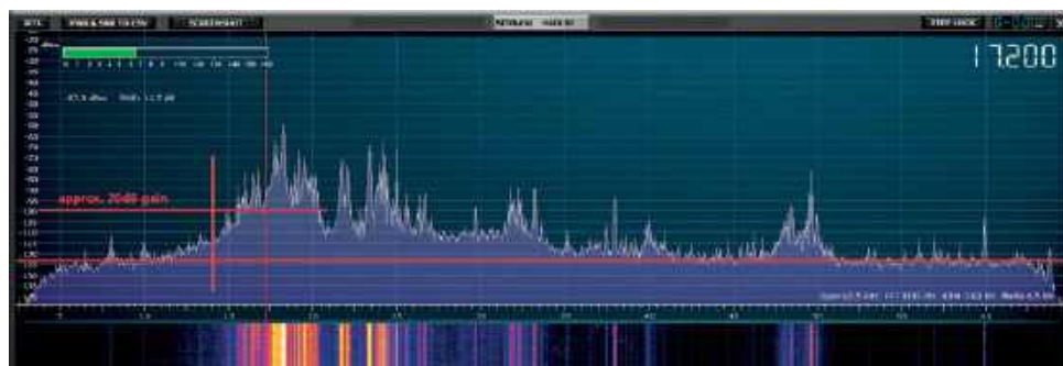
Fot. 8. Oszacowanie wzmocnienia układu w obszarze rezonansu obwodów wejściowych
