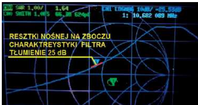
Rys 9. Miejsce resztek nośnej wytłumionej w modulatorze na zboczach filtra (dodatkowe tłumienie 25dB)
