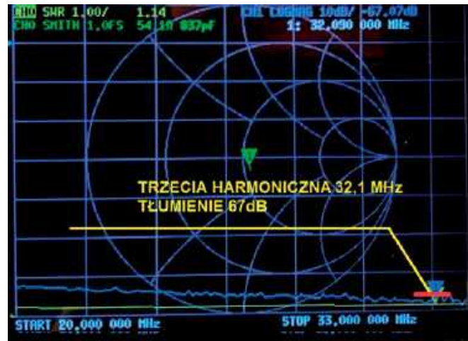
Rys 8. Tłumienie trzeciej harmonicznej
