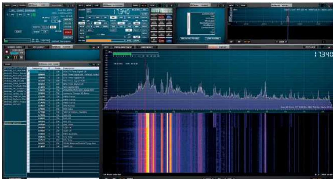
Fot. 11. Odbiór sygnałów VLF przy pomocy programu SDRUno (wyjście przedwzmacniacza jest podłączone do wejścia antenowego odbiornika SDR RSP1A firmy SDRPlay)
