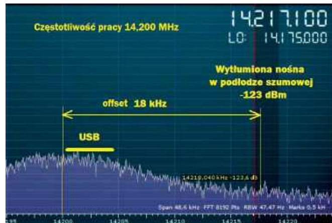
Rys 12. Pomiar po końcowej korekcie wytłumienia
