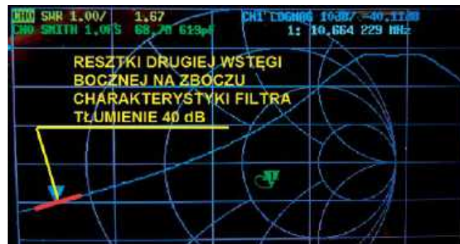
Rys 10. Miejsce resztek niepożądanego wstęgu bocznego wytłumionej w modulatorze na zboczach filtra (dodatkowe tłumienie 40dB)
