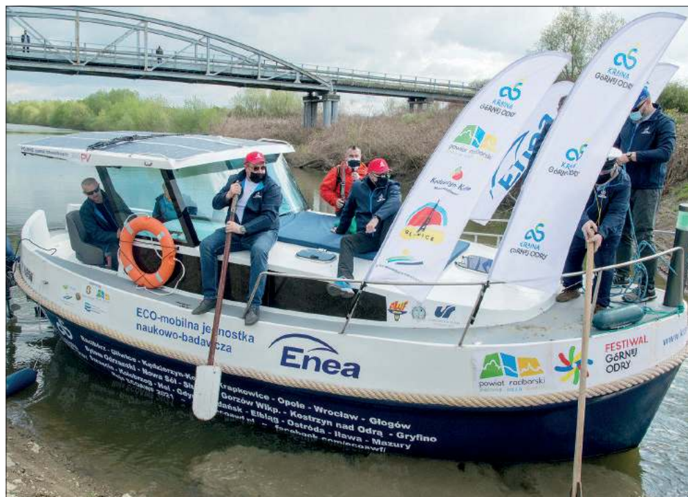
Jacht, który 8 maja wypłynął z Raciborza ma możliwość zasilania energią ze słońca. Dysponuje też silnikiem indukcyjnym, który umożliwia płynięcie przez osiem godzin na napędzie elektrycznym.
