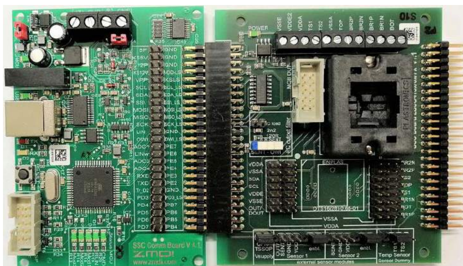
Fotografia 1. Modułowy zestaw ewaluacyjny ZSSC4175EVK ( https://t.ly/kj_z )
