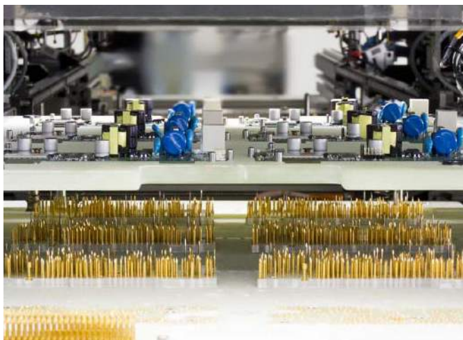
Fotografia 12. Urządzenie do testowania połączeń – Bed of Nails
