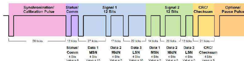
Rysunek 8. Przykładowa ramka danych (w trybie Fast Channel Message) protokołu SENT ( https://t.ly/A7tb )
