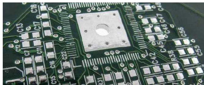
Fotografia 4. Płytkę z pokryciem padów metodą LF HASL
