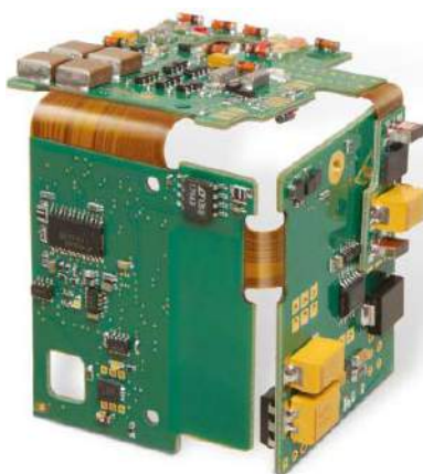
Fotografia 1. Przykład gotowego obwodu wykonanego na płycie PCB sztywno-giętkiej ( rigid-flex )
