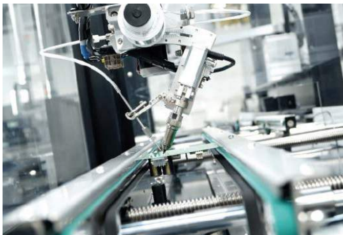
Fotografia 8. Robot lutowniczy w trakcie pracy
