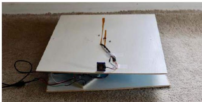
Fotografia 3. Sensor termowizyjny zainstalowany na górnej płytce mechanizmu
