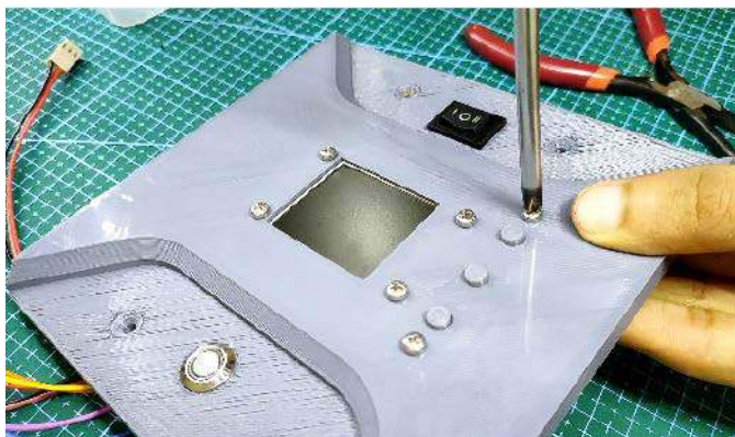
Fotografia 1. Panel przedni urządzenia, wykonany w technice druku 3D
