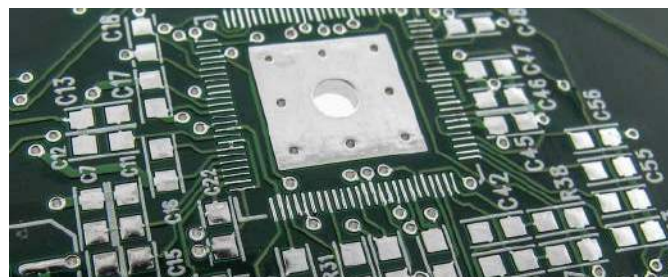
Fotografia 4. Płytkę z pokryciem padów metodą LF HASL
