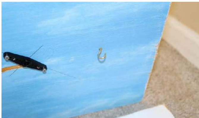
Fotografia 2. Uchwyt na sprężynę napinającą serwo
