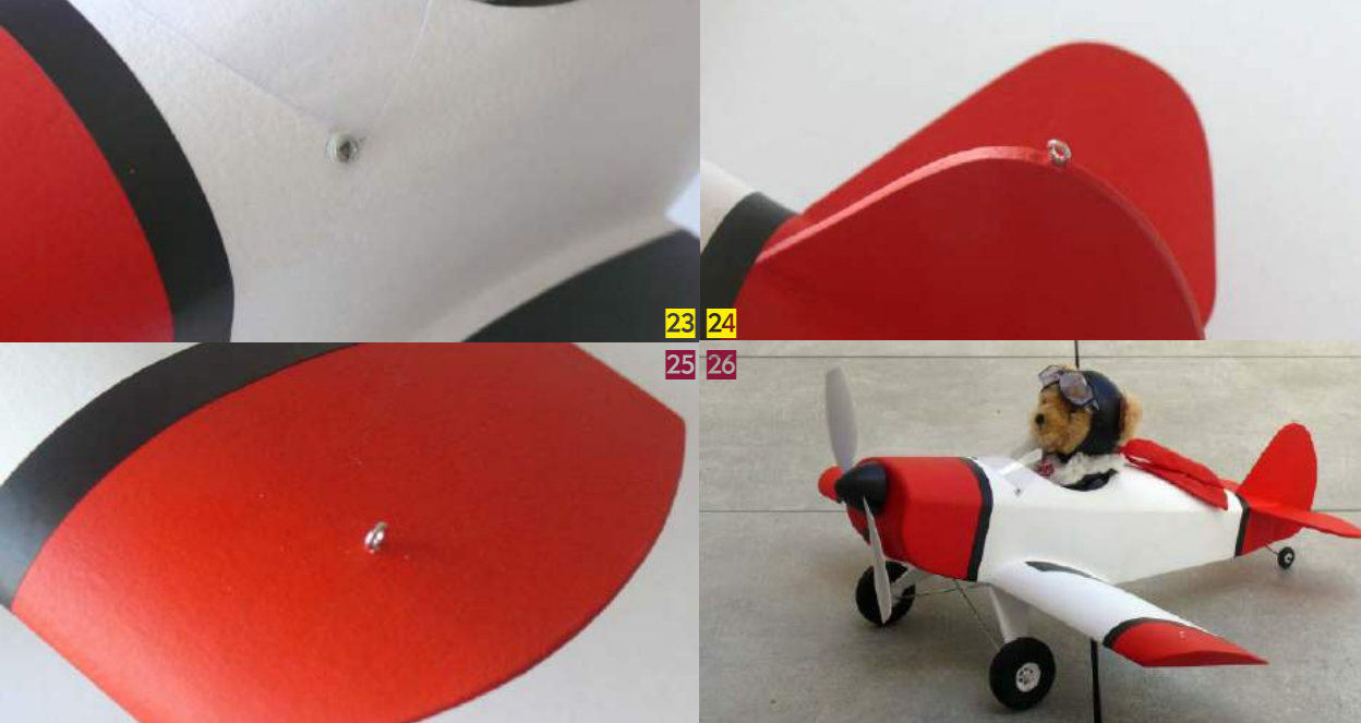
23. Trzypunktowe mocowanie owiewki z folii trzema wkrętami w zaimpregnowanych otworach poszycia (na „szybkę” wystarczy okładka do bindowanych dokumentów A4 lub butelka PET). 24. Zaczep do podwieszenia modelu w usterzeniu pionowym – też lepiej uwzględnić go na etapie sklejania elementów i nie zapomnieć o wzmocnieniu gniazda wkrętu impregnacją C-A 25. Wkręty oczkowe w skrzydłach osadzone są we wcześniej przygotowane wzmocnienie na skrajnych żebrach. 26. „Sesja lotniskowa!”
