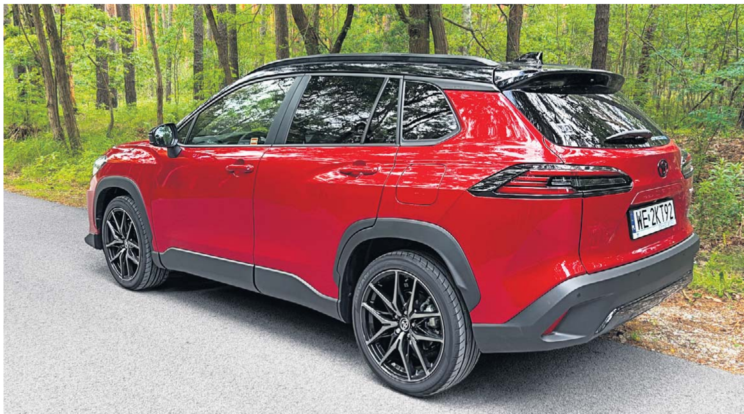
Corolla Cross w wersji GR Sport ma 19-calowe felgi, dach w kolorze czerni fortepianowej i obniżone o 10 mm zawieszenie. Pod maską kryje układ napędowy składający się z 2-litrowego, czterocylindrowego silnika benzynowego i silnika elektrycznego
