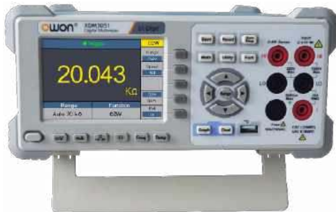
Fotografia 1. Multimetr Owon XDM3051, w opinii autora najlepszy miernik 5½ cyfry dostępny na polskim rynku ( https://tiny.pl/xs8p3yh )
