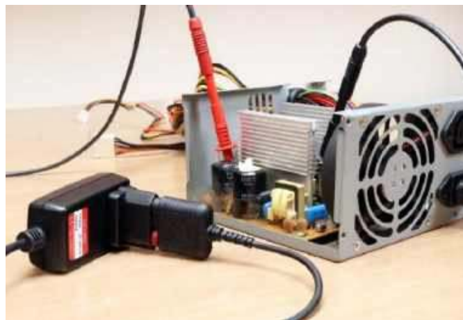
Fotografia 4. Zastosowanie analizatora Handyscope TP450 do pomiarów zasilacza ATX
