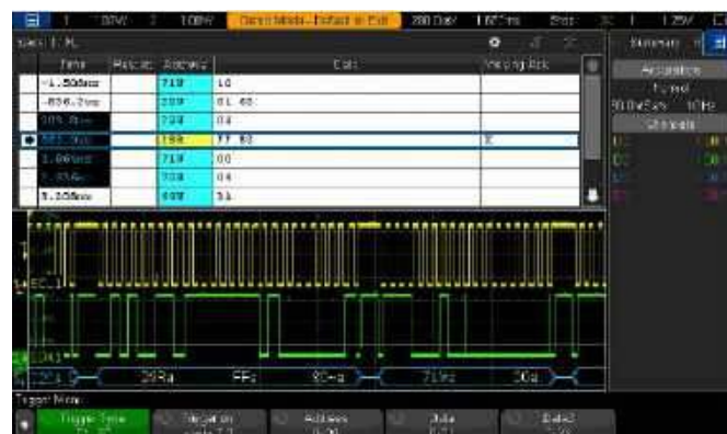
Rysunek 7. Funkcja dekodowania magistrali I 2 C z kanałów analogowych oscyloskopu DSOX3000 ( https://t.ly/Usw7K )
