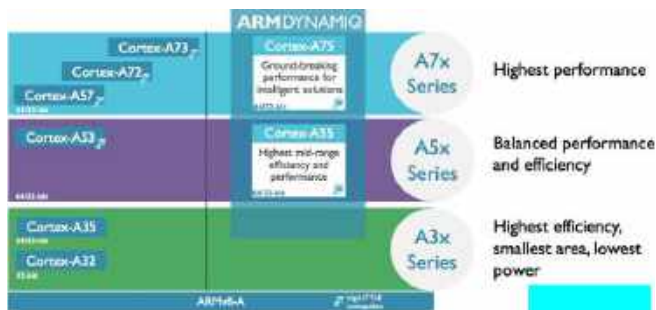
Rysunek 14. Porównanie rdzeni z serii Cortex-A na bazie architektury ARMv8-A ( https://tiny.pl/ybn57y0z )
