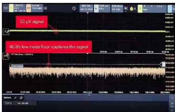
Rysunek 6. „Namierzanie” sygnału na poziomie 53 µV za pomocą funkcji FFT w oscyloskopie HD3 marki Keysight ( https://t.ly/E0NgG )
