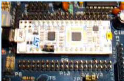
Fotografia 4. Moduł NUCLEO-STM32L432KC przygotowany do pracy
