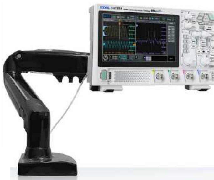
Fotografia 19. Oscyloskop z serii DHO800 marki Rigol zamontowany na wysięgniku przeznaczonym do monitorów komputerowych ( https://t.ly/KA9sf )
