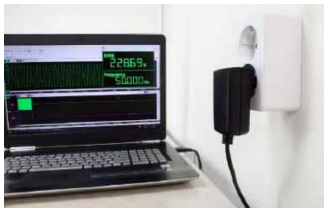
Fotografia 5. Zastosowanie analizatora Handyscope TP450 do pomiarów napięcia sieciowego
