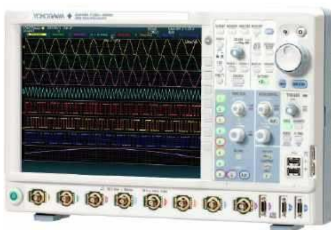
Fotografia 14. Przykładowy oscyloskop 8-kanalowy – archiwalny model DLM4000 marki Yokogawa ( https://t.ly/-N1rK )
