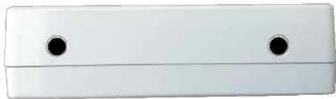
Fotografia 5. Obudowa z wykonanymi otworami (widok z przodu)
