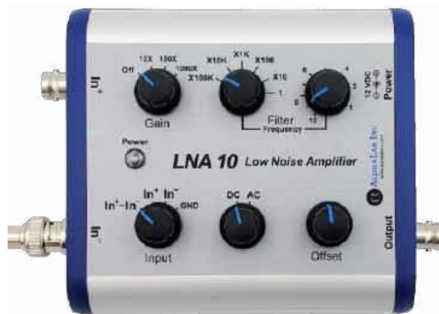
Fotografia 3. Różnicowy przedwzmacniacz oscyloskopowy LNA10 firmy Alpha Lab Inc. ( https://tiny.pl/5kty1-zv )
