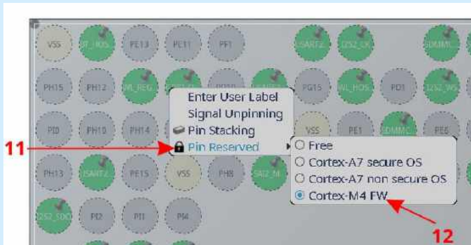
Rysunek 6. Przypisanie rdzenia do wyprowadzenia GPIO
