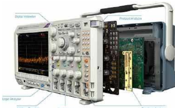
Fotografia 6. Budowa oscyloskopu z serii MDO3000 z widocznym portem rozszerzeń sprzętowych (https://t.ly/BvxpA)
