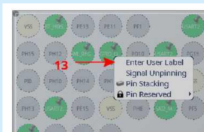
Rysunek 5. Przypisanie opcjonalnej nazwy pinu GPIO
