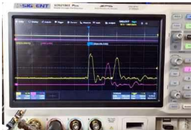
Fotografia 4. Przykład zastosowania długiego rekordu próbek oraz funkcji lupy czasowej (horizontal zoom) – https://t.ly/dyRMW
