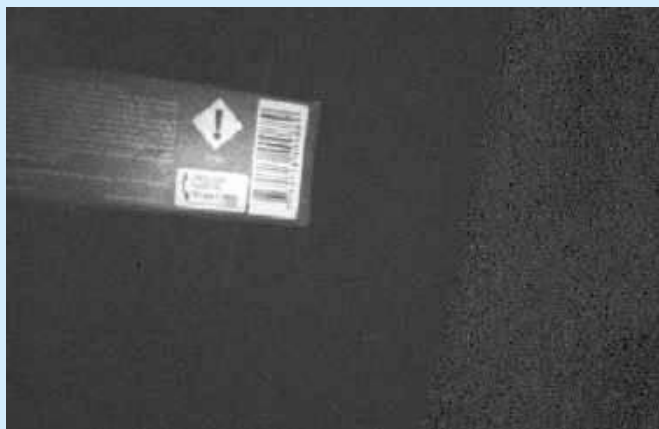
Fotografia 9. Test odczytu niewielkiego kodu 1D z dużej odległości oraz w trakcie ruchu
