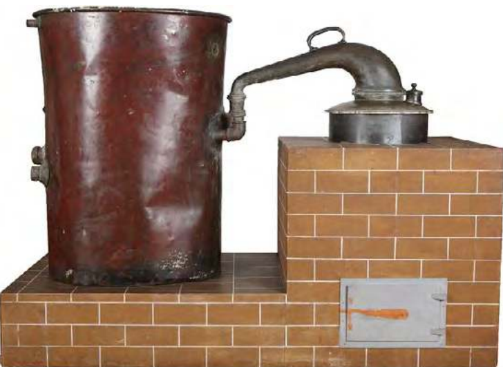
Fotografia 5. Aparat destylacyjny Ignacego Łukasiewicza, z II poł. XIX w., znajdujący się w Muzeum Regionalnym PITK im. Ignacego Łukasiewicza w Gorlicach; Źródło: Wirtualne Muzea Małopolski, http://muzea.malopolska.pl/obiekty/-/a/26927/1133992
