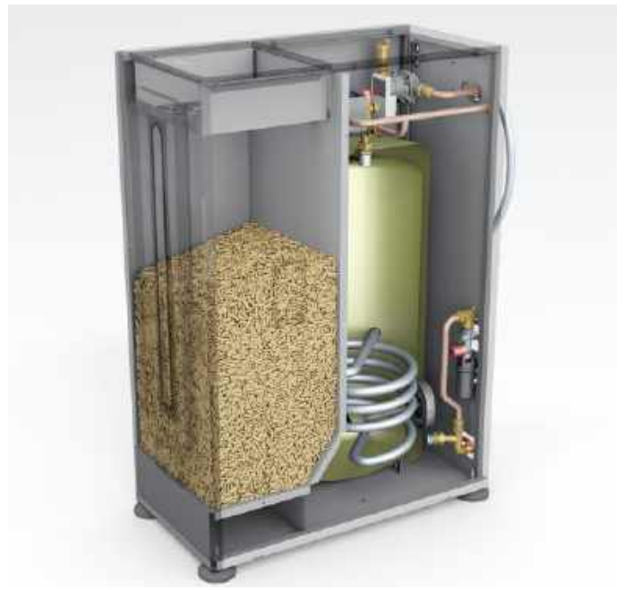
Kocioł na pelety wyposażony jest m.in. w zaizolowany zasobnik do produkcji c.w.u. ze stali nierdzewnej, wbudowany zbiornik buforowy, pompę obiegową c.o., naczynia wzbiorcze do c.o. i c.w.u., odpowietzniki i zawory bezpieczeństwa. MORA
