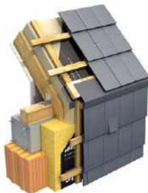
📌 Dachówki na elewacji układa się luźno, ale konieczne jest mechaniczne mocowanie każdej. WIENERBERGER
