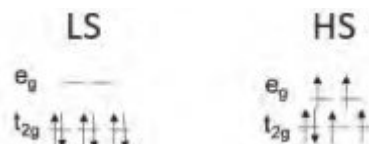
Rys. 5. Skrócona konfiguracja elektronowa jonu metalu o sześciu elektronach walencyjnych w niskim i wysokim stanie spinowym [1]
