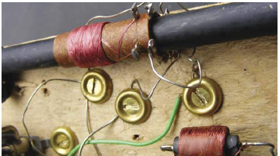
Rysunek 32. Długofalowa cewka antenowa; zauważ jak dwa oddzielne uzwojenia są połączone pod spodem, żeby uzyskać odczep
