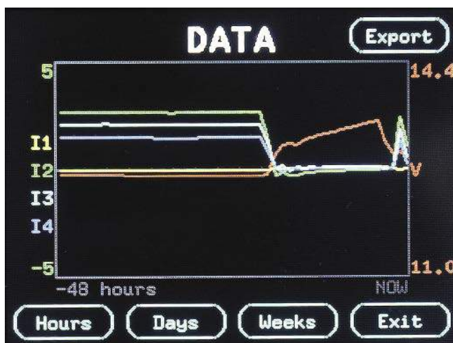
Ekran 2. Ekran danych zapewnia graficzny widok zarejestrowanych danych. Można wyświetlać różne przedziały czasowe, a wyświetlacz będzie automatycznie przewijany raz na minutę, aby pokazać bieżące dane. Opcja Weeks (Tygodnie) zapewnia dane z okresu około dwóch tygodni. Dane mogą być również zrzucane jako arkusze CSV przez port szeregowy konsoli za pomocą przycisku Export
