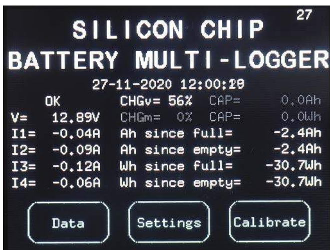
Ekran 1. Ekran główny zapewnia prezentację wszystkich krytycznych statystyk dotyczących akumulatora, a także trzy proste opcje menu umożliwiające dostęp do innych funkcji. Wartości pokazane na szaro to obliczenia pojemności akumulatora, które nie są jeszcze prawidłowe, ponieważ rejestrator nie wykrył pełnego cyklu ładowania i rozładowania; zaświecą się jaśniej, gdy to nastąpi
