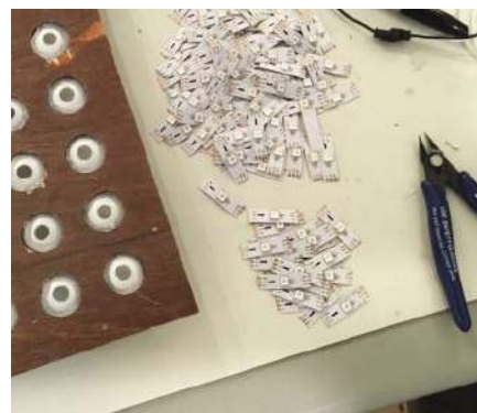
Rysunek 3. Cięcie segmentów NeoPixel
