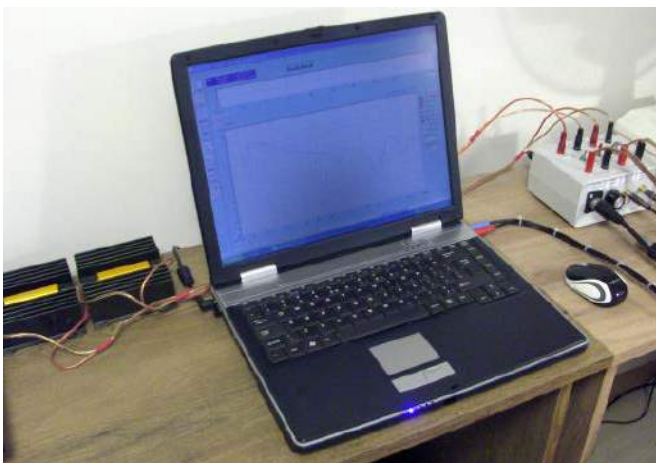
Rysunek 8. Kompletny system pomiarowy składający się ze sztucznego obciążenia, przystawki oraz komputera wykorzystującego program audioTester
