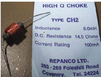
Rysunek 30. Repanco CH2 RFC. Ten wykorzystuje nawinięcie koszykowe i licę, aby zminimalizować straty
