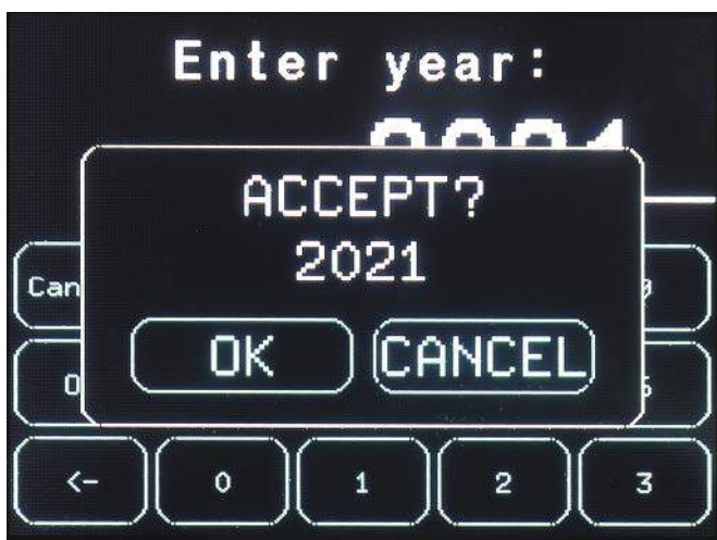
Ekran 5. Każda wprowadzona wartość jest sprawdzana przed przetworzeniem i zapisaniem, aby zapewnić możliwość bezpiecznego wprowadzania zmian
