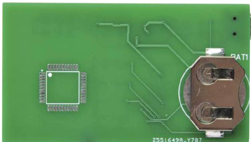
Na spodzie płytki drukowanej znajduje się zestaw styków TQFP. Służy on do ćwiczenia lutowania i nie ma żadnego połączenia elektrycznego z obwodem
