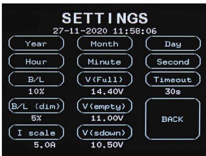
Ekran 3. Ekran ustawień zawiera najczęściej używane opcje konfiguracji rejestratora, w tym napięcia baterii, godzinę i datę oraz sterowanie podświetleniem. Każdy wpis jest sprawdzany, aby upewnić się, że nie koliduje z innymi wartościami (takimi jak napięcie „Rozładowany” jest wyższe niż napięcie „W pełni naładowany”), a następnie natychmiast zapisywany w pamięci FLASH
