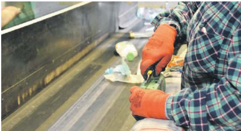
Nie każdy plastik nadaje się do wytwarzania paliwa alternatywnego. Dlatego musi być dokładnie oddzielony, np. z cennych butelek pet trzeba zdjąć foliowe opaski z PCV. Tym zajmują się ludzie
