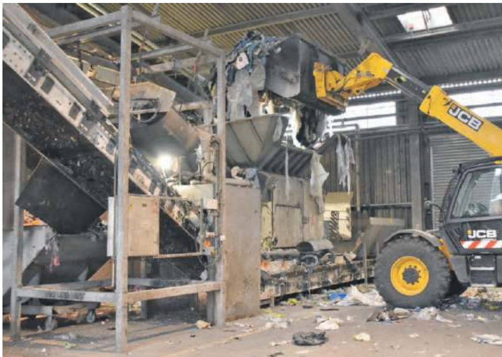
Najpierw odpady zmieszane trafiają do pojemnika, z którego po rozerwaniu worków wędrują na taśmociąg
