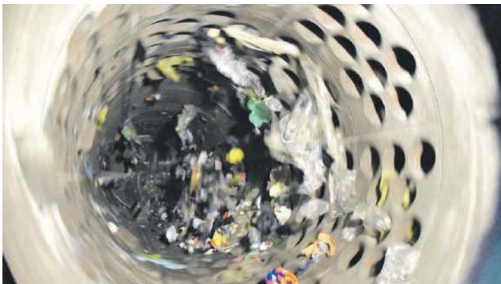
Pierwszy przesiew odpadów następuje na ogromnym obracającym się sicie
