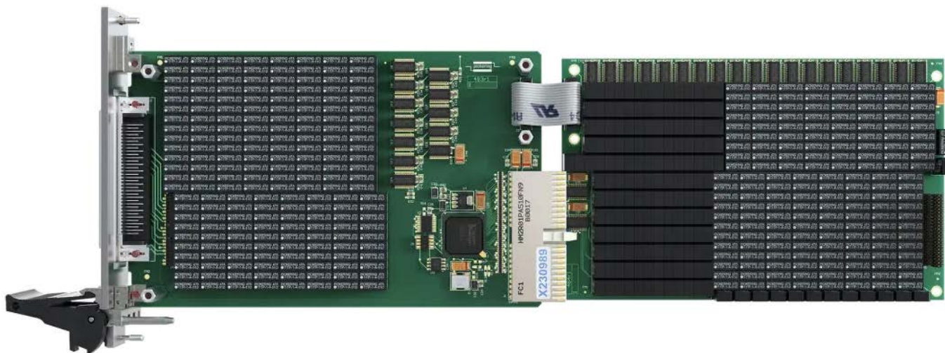
Fotografia 4. Zestaw dwóch kart rozszerzeń w standardzie PXI, zawierających łącznie 512 przekaźników kontaktowych z serii 111P i 117 marki Pickering ( https://t.ly/rx3lw )
