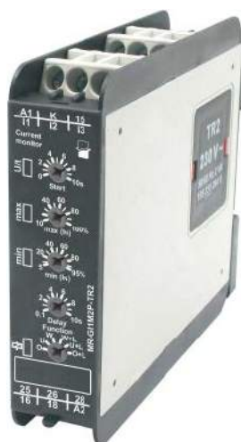
Fotografia 22. Wielofunkcyjny przełącznik nadzorczy w wersji przemysłowej (seria MR-G11M2PTR2 marki Relpol – https://t.ly/kyBm )
