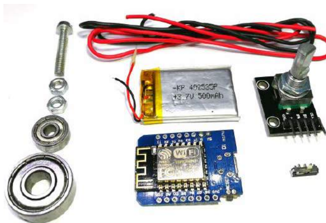
Fotografia 1. Elementy potrzebne do budowy inteligentnej skakanki
