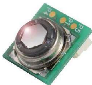
Fotografia 3. Czujnik temperatury z serii D6T marki Omron ( https://t.ly/ek0q )
