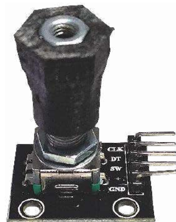
Fotografia 3. Enkoder wraz z zainstalowanym wydrukowanym elementem
