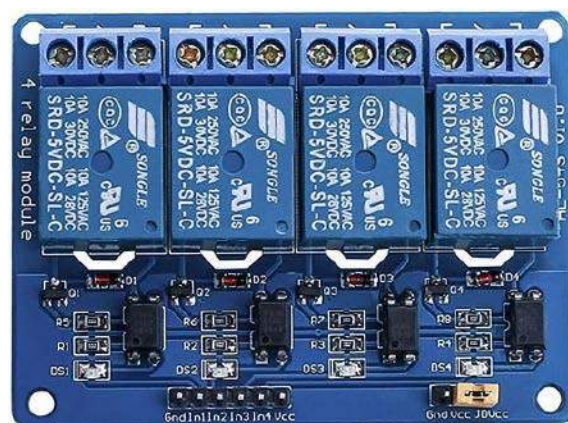
Fotografia 10. Moduł przekaźnikowy z optoizolatorami ( https://t.ly/F_s0 )
