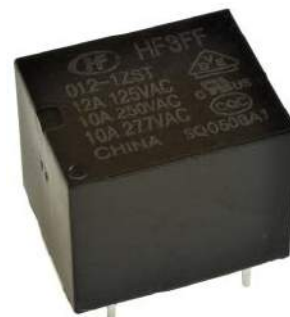
Fotografia 4. Przekaznik HF3FF produkcji Hongfa ( https://bit.ly/3N3tM6d )
