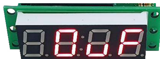
Fotografia 3. Sposób sygnalizacji przepełnienia licznika
