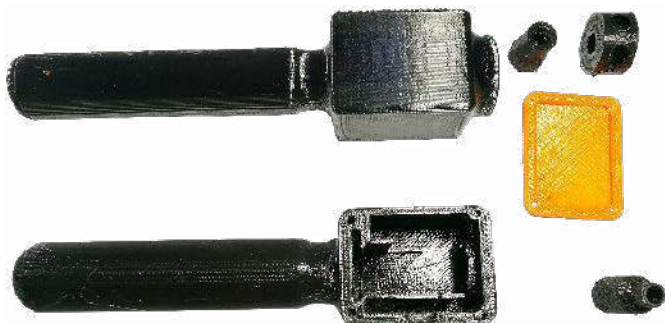
Fotografia 2. Elementy obudowy i konstrukcji mechanicznej skakanki z druku 3D
