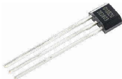
Fotografia 1. Czujnik GX18B20S w obudowie TO92S
