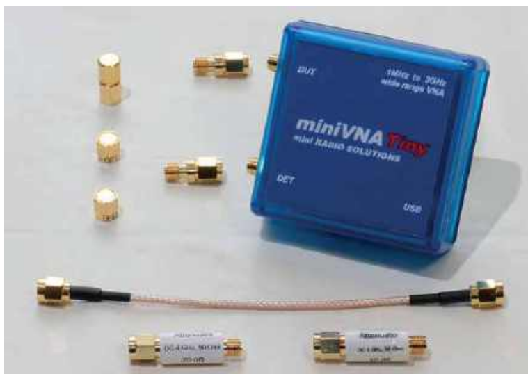
Analizator miniVNA Tiny z akcesoriami
