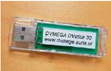
Fot. 3. Moduł wokodera AMBE3000 USB
