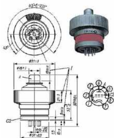
Rys. 1. Konstrukcja i wyprowadzenie cokołu GU-74B
