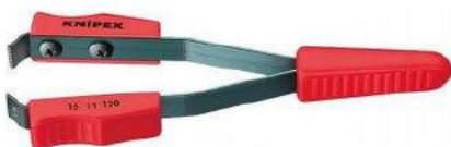
Rysunek 16. Pinceta „Knipex”, służąca do zdzierania emalii z drutu nawojowego emaliowanego przed lutowaniem, kod producenta: 825448012, EAN: 4003773015550 ( https://www.knipex.com )
