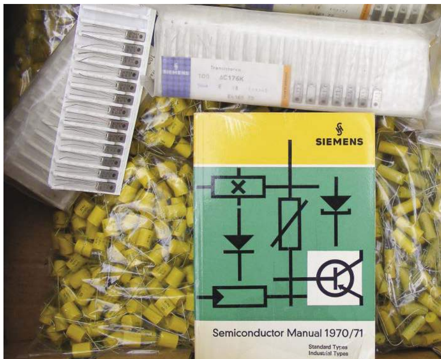
Rysunek 2. Dobra sterta starych „poprawnych” komponentów z przewodami i oznaczeniami. Germanowe tranzystory wyjściowe Siemens i kondensatory polistyrenowe z folii otwiniowej „Minipoco” firmy Philips o tolerancji 1%. Po 35 latach nadal ich dokładność wynosi 1%
