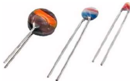
Rysunek 11. Przykłady elementów NTC (Jos Verstraten)
