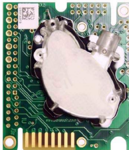
Rysunek 7. Nowoczesny czujnik NDIR z miniaturową komorą próbkową
