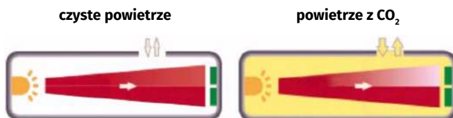
Rysunek 3. Zasada działania czujnika NDIR
