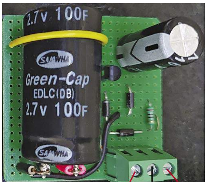
Rysunek 1. Prototyp zasilania zegara z wykorzystaniem solarnego panelu FV i superkondensatora
