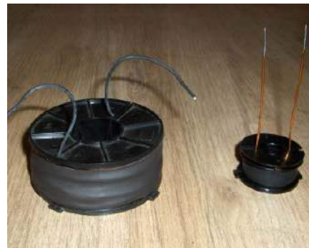
Rysunek 6. Cewki powietrzne zabezpieczone po nawinięciu rurami termokurczliwymi
