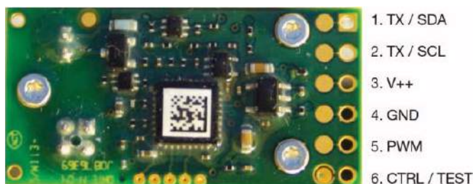
Rysunek 21. Dane dotyczące połączenia czujnika T6713
