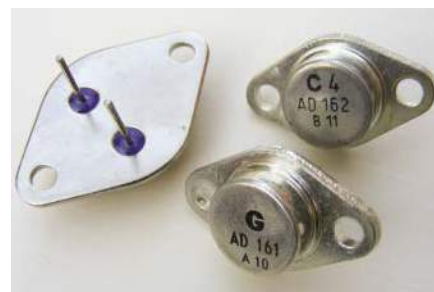
Rysunek 11. Tranzystory wyjściowe Mullard AD161/2 (po prawej). Bardzo popularny typ w latach 70-tych. Robert's użył ich w swoim radiu stółowym RM50 wraz z głośnikiem Celestion. Zwróć uwagę na ich małą obudowę T066 w porównaniu do standardowej T03 (po lewej)
