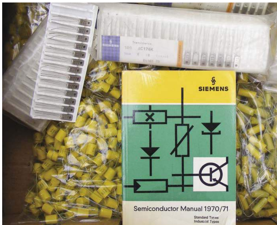
Rysunek 2. Dobra sterta starych „poprawnych” komponentów z przewodami i oznaczeniami. Germanowe tranzystory wyjściowe Siemens i kondensatory polistyrenowe z folii otówiowej „Minipoco” firmy Philips o tolerancji 1%. Po 35 latach nadal ich dokładność wynosi 1%
