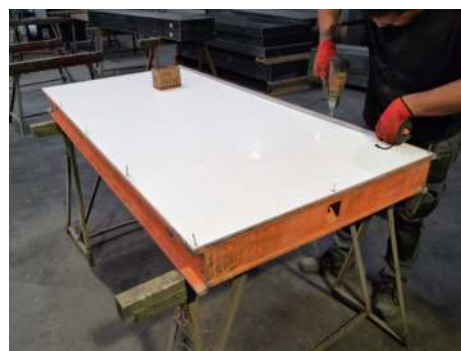
Fot. 3. Panele systemu stropowego BAUDECK Baukrane
