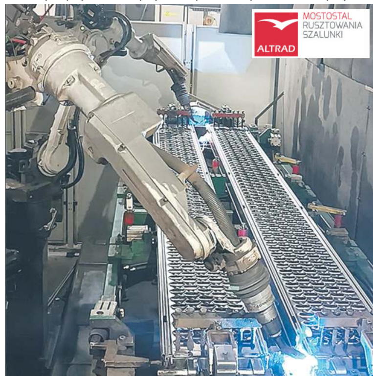
Spawanie pomostów przy użyciu robota
