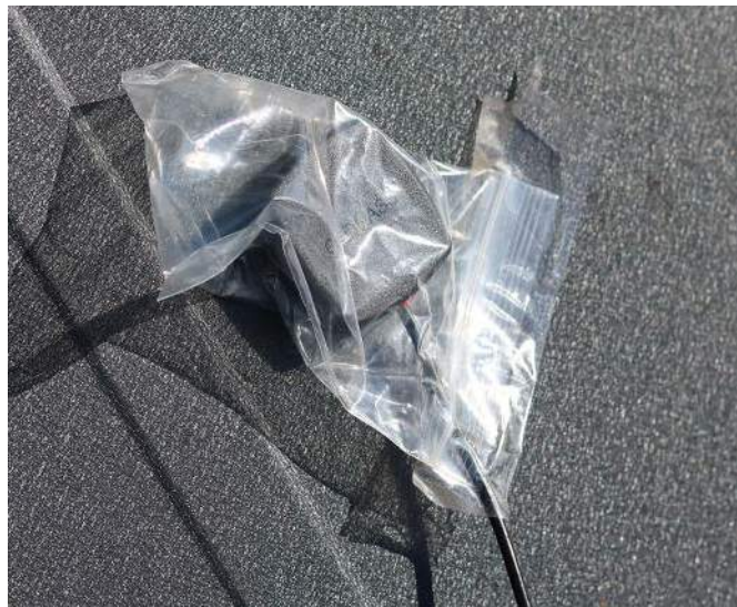
Fotografia 1. Niewielka antena GPS musi być umieszczona w miejscu z widokiem na niebo, np. na dachu
