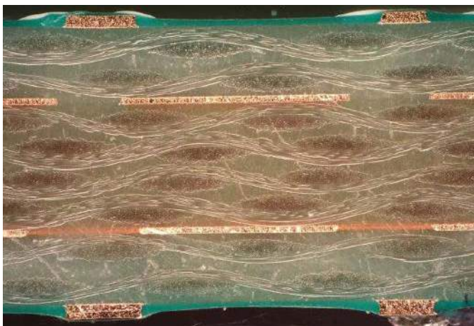
Fotografia 7. Przekrój czterowarstwowej płyty na bazie laminatu szklano-epoksydowego FR4, opracowany w laboratorium firmy Eurocircuits ( https://t.ly/CnfAr )
