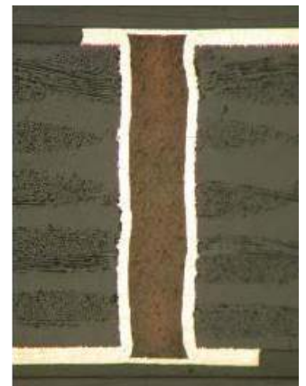
Fotografia 5. Przekrój zatkanej przelotki typu VII z planaryzacją https://t.ly/_ykcd
