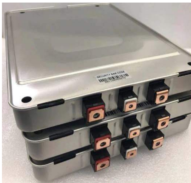
Fotografia 4. Akumulatory LMO stosowane w autach Nissan Leaf
