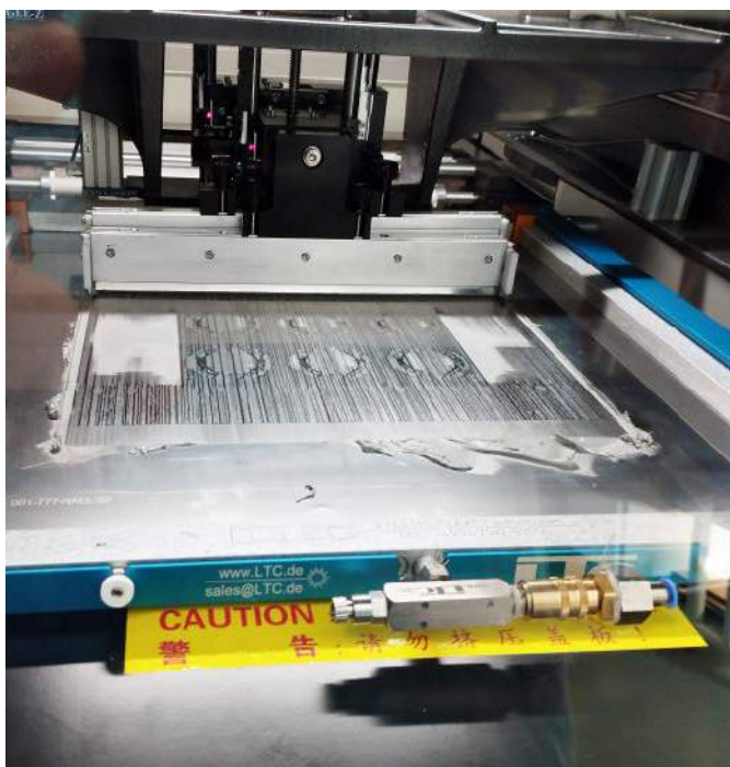
Fotografia 1. Nakładanie pasty lutowniczej w procesie montażu SMT
