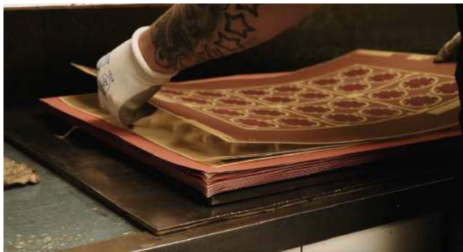
Fotografia 3. Proces ręcznego składania stosu PCB z poszczególnych rdzeni i prepregów ( https://bit.ly/3QcqsFD )
