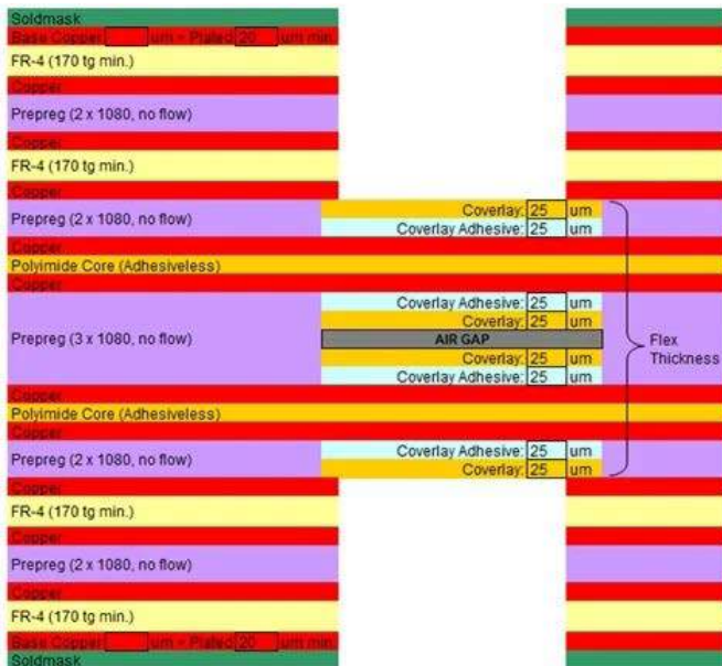
Rysunek 32. Budowa stosu rozbudowanego obwodu rigid-flex z 12 warstwami w części sztywnej i czterema w części elastycznej – kolorem szarym zaznaczono slot powietrzny pomiędzy dwoma pasmami laminatu elastycznego ( https://t.ly/QN1Ku )
