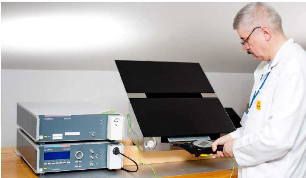
Fotografia 6. Test odporności na wyładowania elektrostatyczne (ESD)
