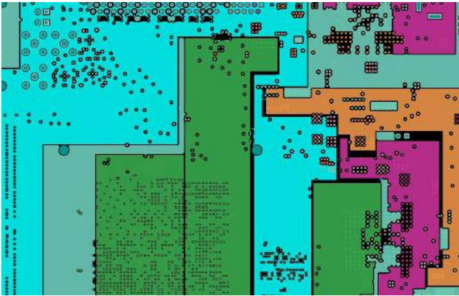
Rysunek 9. Przykład płaszczyzny zasilania, podzielonej na szereg sekcji o różnym przeznaczeniu (np. zasilanie części analogowej, cyfrowej i RF) oraz różnych poziomach napięcia ( https://t.ly/DnLRY )
