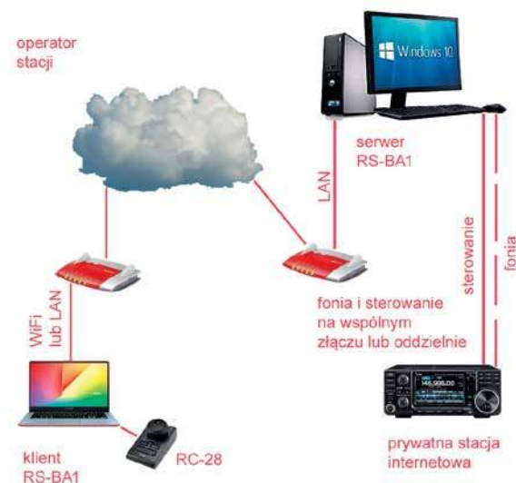
Rys. 2. Prywatna stacja internetowa. Przykład z oprogramowaniem Icom, dla modeli innych producentów używane jest ich oprogramowanie serwera i klienta. Powszechnie znane programy sterujące jak Ham Radio Deluxe, TRX Manager obsługują również duży wybór modeli radiostacji, ale konieczne jest zainstalowanie programu do transmisji dźwięku (Skype itp.)
