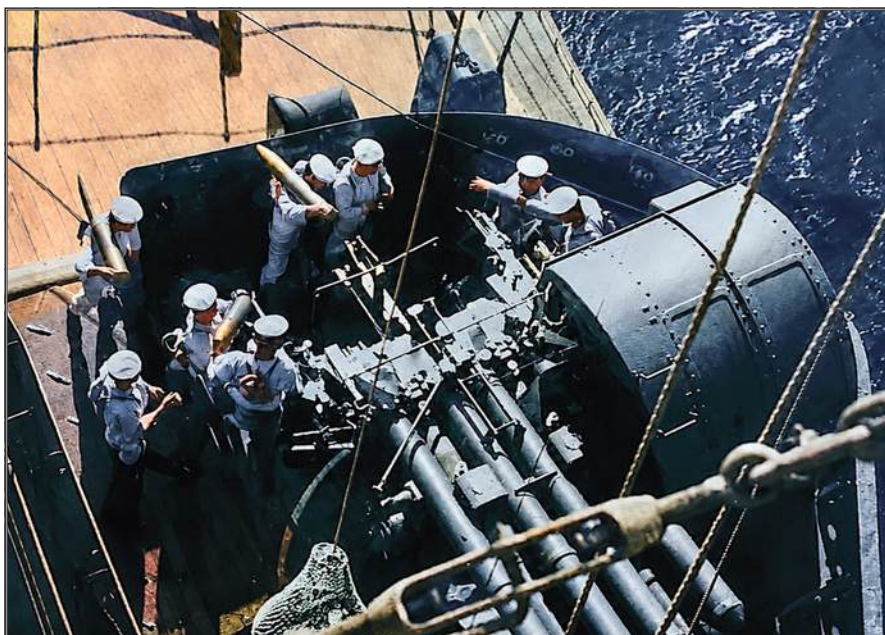
Obługa dwudziałowego stanowiska A-1 armat uniwersalnych kal. 127 mm L/40 89-Shiki. Uzbrojenie to stanowiło podstawę ciężkiej artylerii przeciwlotniczej japońskich okrętów (nie tylko pancerników). Mimo relatywnie dobrych właściwości balistycznych i znacznego zasięgu skuteczność systemu ograniczały niska szybkostrzelność praktyczna, mała prędkość naprowadzania oraz niedostatki japońskich systemów kierowania ogniem przeciwlotniczym.
