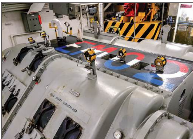
Obudowa dwustopniowej przekładni redukcyjnej General Electric z pancernika typu Iowa stworzyła podwaliny pod przyszłe systemy skonteneryzowane. Zintegrowanie przekładni, łożysk i układów pomocniczych w jednym zespole, a do tego zagwarantowanie im bezpiecznej pracy i wyciszenia było równie istotnym osiągnięciem jak sama konstrukcja przekładni.
