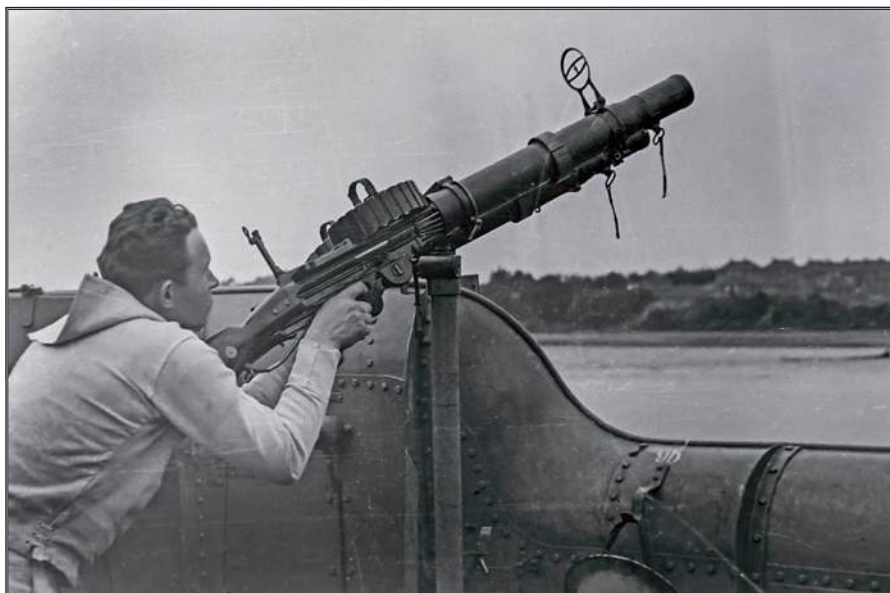
W odpieraniu ataków powietrznych pod Bougie nadal uczestniczyły też zdwojone karabiny maszynowe Levis kal. 7,7 mm, lecz przeniesione kolejny raz, tym razem z pomostu dowodzenia na skrzydła pomostu nawigacyjnego. Zdjęcie z albumu sygnalisty Edwarda Gatnera z okresu wcześniejszego.
