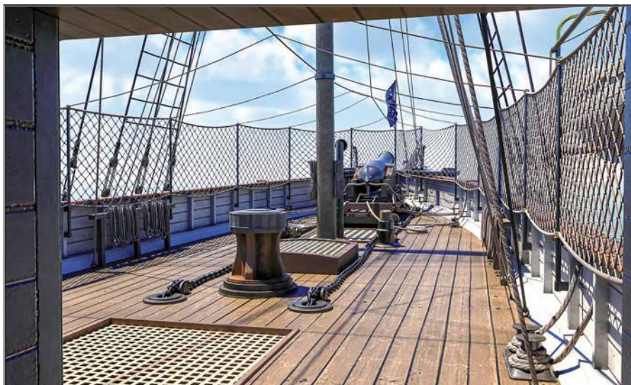
Pokład dziobowy. Stanowisko gwintowanego, 30-funtowego dział Parrotta na lawecie obrotowej oraz łańcuchy kotwiczne.
