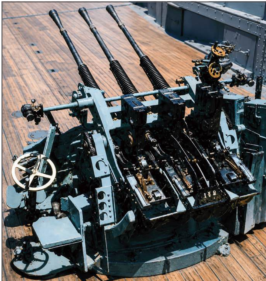
Trójdziałowe stanowisko MG AS armat automatycznych kal. 25 mm L/60 96-Shiki bez osłony przeciwodłamkowej. Uzbrojenie to stanowiło podstawowy środek obrony przeciwlotniczej bezpośredniego zasięgu japońskich okrętów. Mimo ciągłego zwiększania liczby tych stanowisk uzbrojenie to nie było w stanie skutecznie pełnić swojej funkcji. Niewielka masa pocisku, małe magazynki oraz brak nowoczesnych systemów kierowania ogniem sprawiły, że wzrost liczby armat nie przekładał się proporcjonalnie na wzrost zdolności przeciwlotniczych.
