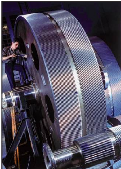
Koła zębate dwustopniowej przekładni redukcyjnej General Electric. Rozwiązanie zastosowane na pancernikach typu Iowa wyznaczyło standard dla wielkich siłowni turbinowych i przez dziesięciolecia pozostawało jednym z najbardziej zaawansowanych układów przeniesienia mocy w okrętownictwie.
