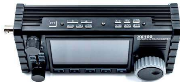
Klawisze na górnej ścianie. Sześć klawiszy po prawej stronie ma przypisane po dwie funkcje. Są one podpisane odpowiednio na klawiszach i obok nich
