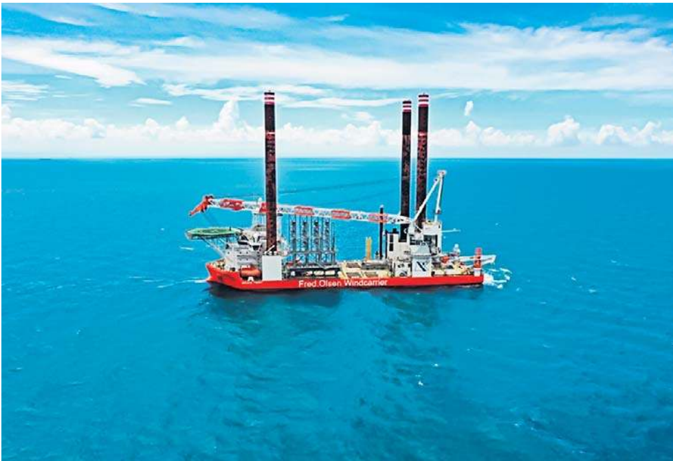
Statek typu jack-up może pomieścić 7 kompletów turbin wiatrowych o mocy 15 MW
