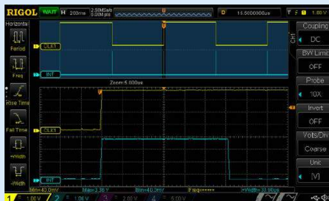
Rysunek 5. Przebiegi Clock1Hz oraz Int
