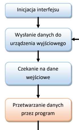
Rysunek 13. Uproszczony schemat programu pokazujący działanie algorytmu przetwarzania danych
