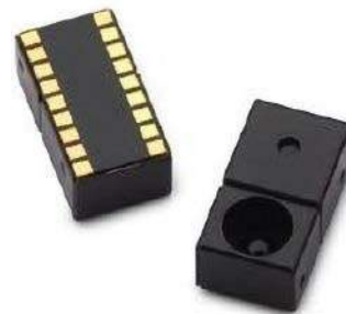
Fotografia 17. Czujniki gestów APDS-9500 ( https://t.ly/kkbv )
