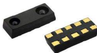
Fotografia 15. Czujniki VCNL4200 marki Vishay ( https://t.ly/hL52 )
