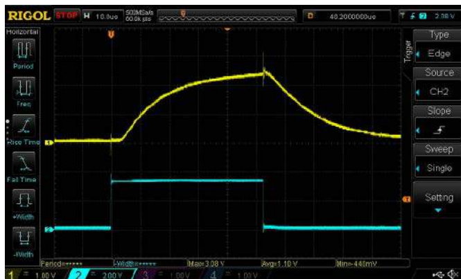
Rysunek 5. Przebieg na wyjściu dzielnika napięcia z fototranzystorem (CH1), oświetlonym przez diodę LED zasilaną przebiegiem prostokątnym (CH2) – https://t.ly/Mn2jL
