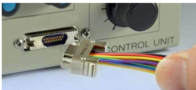
Fotografia 19. Przykładowe złącze typu Nano-D marki Omnetics (https://t.ly/qnP5)
