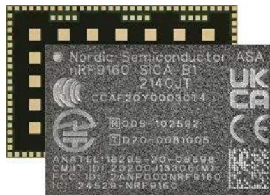
Fotografia 6. Wygląd modułu nRF9160 realizującego komunikację LTE-M i NB-IoT oraz umożliwiającego odbiór sygnału GPS
