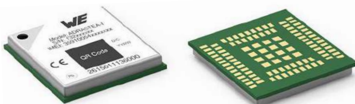
Rysunek 12. Moduł Adrastea-I to najnowszy produkt Würth Elektronik, który pozwala na obsługę zarówno LTE-M jak i NB-IoT
