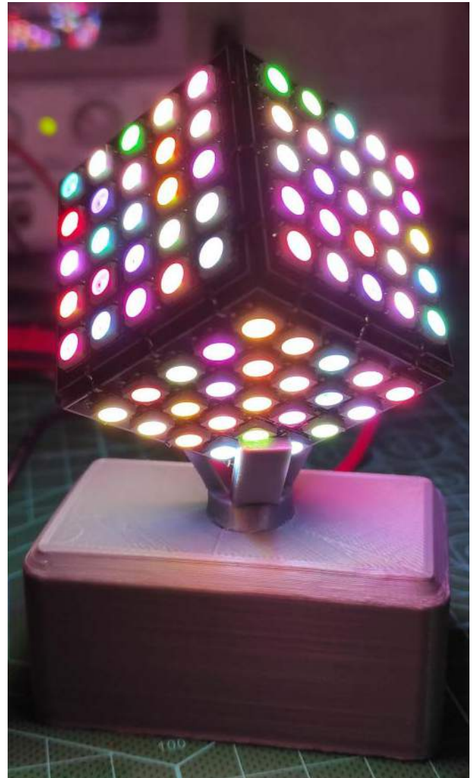
Fotografia 5. Kostka RGB LED na podstawce
