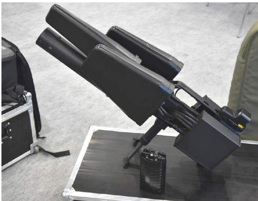
Fotografia 1. Urządzenie EDM4S do zakłócania działania dronów
