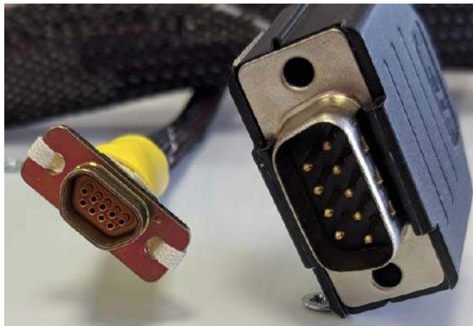
Fotografia 16. Porównanie rozmiarów standardowego złącza D-Sub z odpowiadającym mu złączem w wersji Micro-D (https://t.ly/lQvm)
