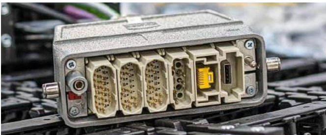
Fotografia 10. Przykładowa konfiguracja złącza Han-Modular z trzema sekcjami sygnałowymi w gęstym rastrze, jedną sekcją z pinami o większym przekroju oraz łączami Ethernet i USB (https://t.ly/lvOd)
