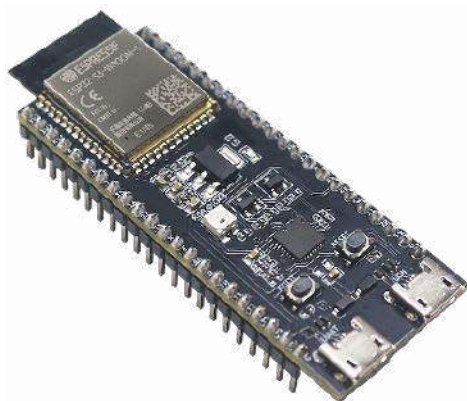
Fotografia 2. Płytki uruchomieniowa ESP32-S3-DevKitC-1 z modułem ESP32-S3-WROOM-1
