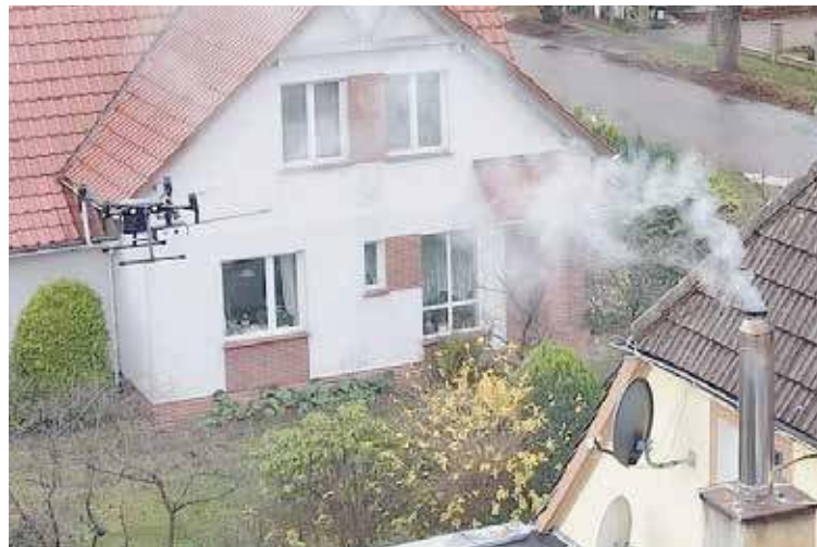
Specjalistyczny dron jest w stanie podlecieć bardzo blisko i zbadać czym palono w piecu
