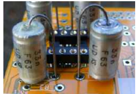
Rysunek 16. Na płytkach filtrów jest wystarczająco dużo miejsca, aby dać kondensatory polistyrenowe o tolerancji 1% – o ile uda się je zdobyć. Do filtrów elektroakustycznych doskonale nadawały się kondensatory Philips z serii 424, ale zostały wycofane z produkcji, ponieważ ich dielektryk zawierał neurotoksyczny ołów
