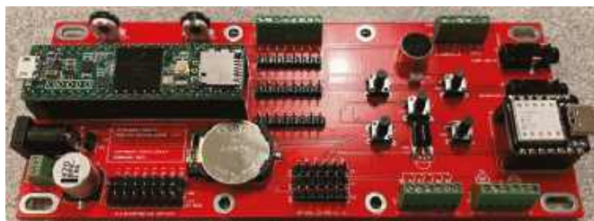
Rysunek 7. Płytkę sterującą, która będzie sterować naszymi 10-znakowymi, 21-segmentowymi wyświetlaczami
