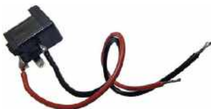
Fotografia 18. Gniazdo baryłkowe z przyłutowanymi kabelkami. Kabelek czerwony (plus) przyłutowany do blaszki na tyle gniazda, kabelek czarny (minus) do blaszki na spodzie gniazda. Boczna blaszka pozostaje nielutowana
