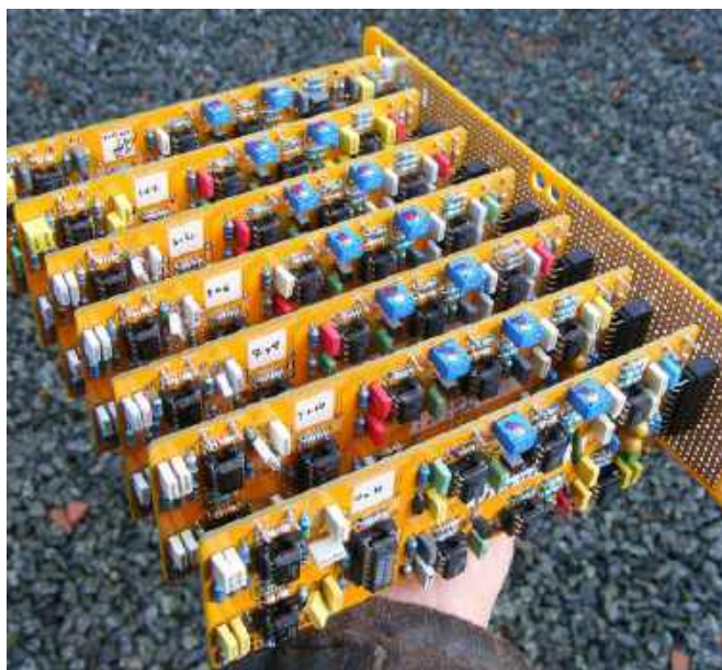
Rysunek 1. Serce wokodera – sześć płytek z filtrami pasmowprzepustowymi i płytka górno-/ dolnoprzepustowa. Wszystko podłączone do magistrali
