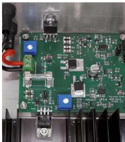
Rysunek 1. Po lewej: sztuczne obciążenie w wersji 18 W, z dużą płytką radiatora. Przykręcenie LM317 plastikową śrubą było kiepskim pomysłem. Po prawej: płytka w pełni zmontowana z dodatkowymi elementami dla wersji do 50 W
