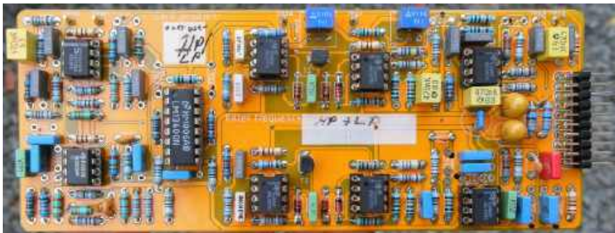
Rysunek 9. W pełni zmontowana płytki „HP/LP”. Jest to wersja wcześniejsza z dodanymi kilkoma elementami do celów eksperymentalnych. Wszystkie płytki sprzedawane przez Practical Electronics są dokładnie zgodne z rysunkami montażowymi
