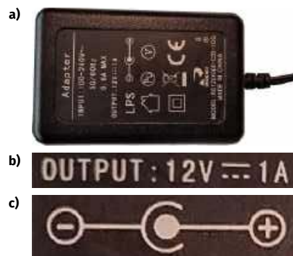
Rysunek 4. Na tabliczce znamionowej a) przykładowego zasilacza, b) widoczny jest napis informujący o tym, że zasilacz ten dostarcza napięcie stałe (symbol podobny do znaku równości z przerywaną dolną linią) o wartości 12 V przy dopuszczalnym natężeniu prądu obciążenia o wartości 1 A oraz c) rysunek pokazujący schemat polaryzacji na wtyczce („plus” wewnątrz i „minus” na zewnątrz). Zasilacz na napięcie 12 V bezpośrednio nie nada się do zasilania naszych układów z mikrokontrolerami
