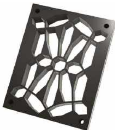
Rysunek 5. Płytkę LED i wydrukowaną na drukarce 3D obudowa 21-segmentowego wyświetlacza: a) płytkę LED (po lewej); b) wydrukowaną na drukarce 3D obudowa (po prawej)
