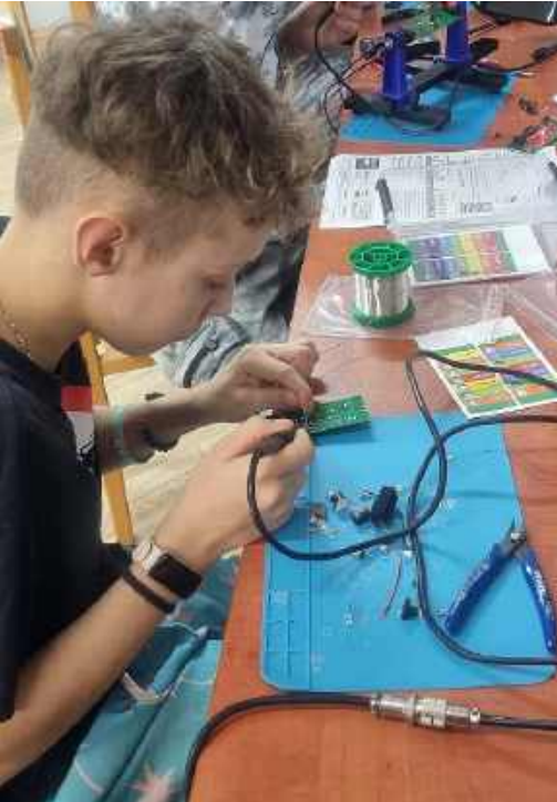
Fotografia 6. Kacper lutuje podstawkę pod mikrokontroler do płytki PCB. Zagięcie po włożeniu do płytki ale jeszcze przed rozpoczęciem procesu lutowania skrajnych dwóch wyprowadzeń podstawki (po przekątnej), np. nóżki 1 i 8, pozwala manewrować płytką, bez obawy o to, że podstawka wypadnie. Młodzi Entuzjaści Elektroniki, Szkoła Podstawowa nr 86, Wrocław
