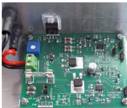
Rysunek 1. Po lewej: sztuczne obciążenie w wersji 18 W, z dużą płytką radiatora. Przykręcenie LM317 plastikową śrubą było kiepskim pomysłem. Po prawej: płytka w pełni zmontowana z dodatkowymi elementami dla wersji do 50 W
