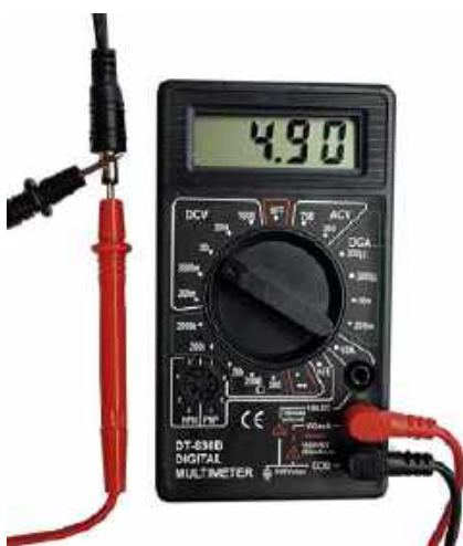
Fotografia 17. Weryfikacja polaryzacji i wartości napięcia stałego na zasilaczu z użyciem multimetru ustawionego na funkcję woltmierzania napięć stałych w zakresie do 20 V. Sonda czerwona została umieszczona wewnątrz wtyku (średnica wewnętrzna) a sonda czarna dotyka średnicy zewnętrznej. Brak znaku „-” przed liczbą na wyświetlaczu potwierdza, że „plus” znajduje się na wewnętrznej średnicy wtyku zasilacza
