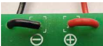
Fotografia 11. Poprawny sposób montażu kabelków do płytki PCB. Czerwony kabelk zamontowany został w otworze oznaczonym znakiem „+” a czarny w otworze ze znakiem „-”
