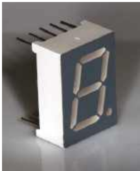
Rysunek 2. Klasyczny 7-segmentowy wyświetlacz LED
