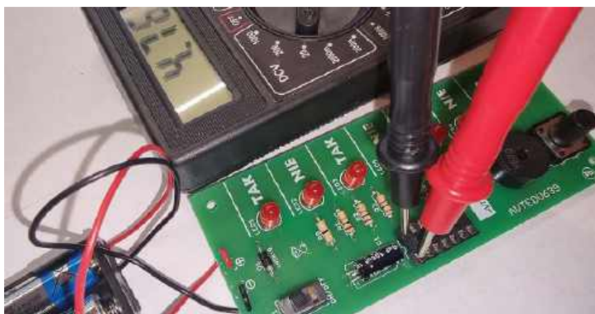
Fotografia 14. Po ustawieniu przełącznika SW1 w pozycji ON (hebelki w stronę najbliższej krawędzi PCB) pomiędzy pinem pierwszym (plus zasilania) oraz czternastym (minus zasilania) powinno znajdować się napięcie nieco poniżej 5 V
