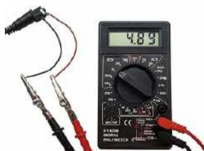
Fotografia 19. Pomiar napięcia na końcach kabelków. Ponownie zmierzono napięcie około 4,9 V a brak znaku przed liczbą świadczy o prawidłowej polaryzacji (plus na czerwonym kabelku). Zwróć też uwagę na zastosowane krokodyłki nałożone na sondy przyrządu pomiarowego, które bardzo ułatwiają codzienną pracę
