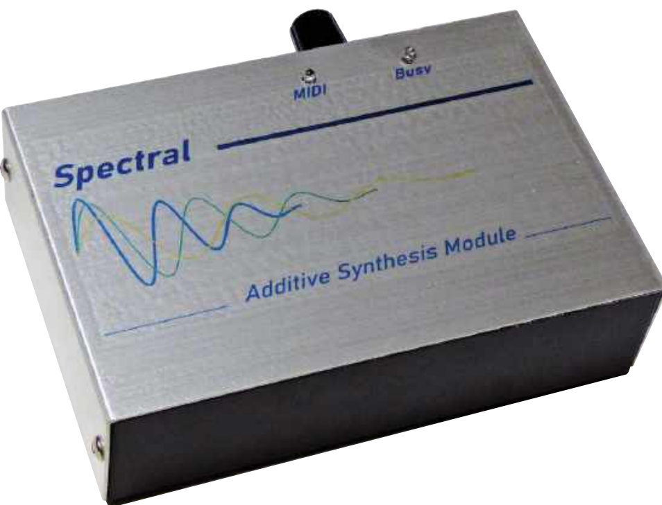
Gotowy syntezator posiada dwie diody LED w górnej części panelu, które wskazują, kiedy odbiera komunikaty MIDI i kiedy komunikuje się z komputerem (np. ładuje patche)
