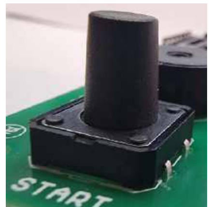
Fotografia 10. Poprawny montaż przycisku start. Wszystkie nóżki przycisku przeszły przez otwory na PCB oraz cała podstawa przycisku leży bezpośrednio na powierzchni PCB
