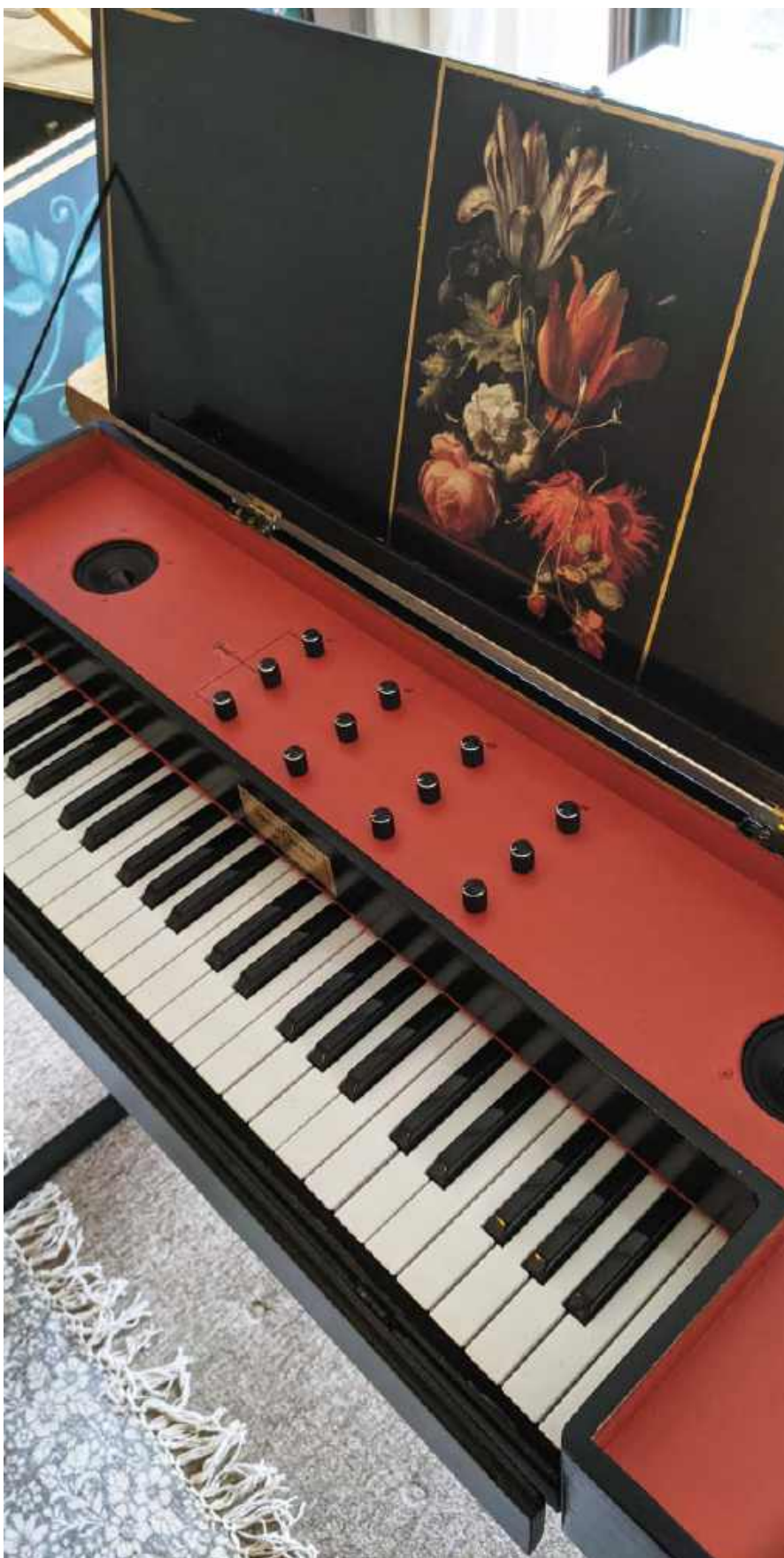
Rysunek 13. Syntezator MIDI został połączony ze standardową klawiaturą kontrolera MIDI, wzmacniaczem i głośnikiem, tworząc ten elektroniczny klawikord
