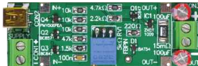
Rysunek 3. Krytyczną czynnością podczas montażu sterownika jest upewnienie się, że nie dojdzie do pomieszenia różnych elementów w obudowach SOT-23. Przed ich przylutowaniem należy sprawdzić oznaczenia na płytce drukowanej. Moduł boost znajduje się nad górną częścią tej płytki drukowanej, co widać na innych zdjęciach. Chociaż sprzężenie zwrotne łączy się elektrycznie z pinem 5 układu scalonego XL6009, zwykle łatwiej jest dołączyć się do wyprowadzenia potencjometru montażowego po sprawdzeniu niskiej rezystancji między nim a pinem sprzężenia zwrotnego układu scalonego
