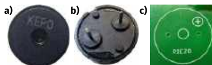
Fotografia 8 a) i b) – brak oznaczeń polaryzacji na pasywnym buzzercie piezo dotychczasom do zestawu, c) znacznik polaryzacji na płytce PCB na wypadek potrzeby użycia bardziej egzotycznego pasywnego buzzera
