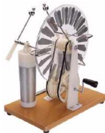
7. Typowy przykład maszyny elektrostatycznej Wimshursta (© AliExpress)
