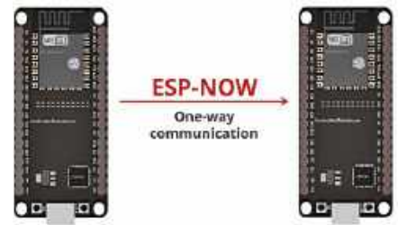
Rysunek 6. Jednokierunkowa komunikacja między modułami ESP32
