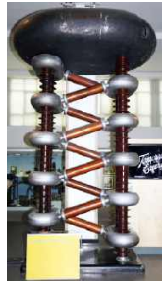
14. Generator Cockrofta-Waltona zbudowany przez firmę Philips w 1937 roku (© 2012 Wikimedia Commons – Geni)
