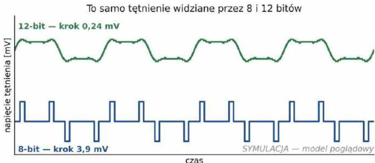
Rysunek 5 To samo miliwoltowe tętnienie: przez 12 bitów czytelne i gotowe do pomiaru, przez 8 bitów (na zgrubnym zakresie) tonące w schodkach kwantyzacji
