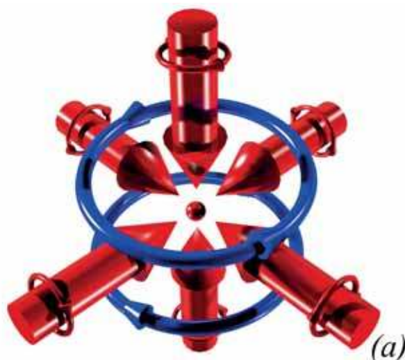
Rysunek 2. (a) 3D magneto-optyczna pułapka. Konfiguracja MOT zgodnie z nazwą łączy elementy magnetyczne i optyczne. Dwie współosiowe cewki (kolor niebieski) z przeciwnymi kierunkami przepływającego prądu (strzałki) zapewniają pole magnetyczne wewnątrz pułapki. Wiązki laserowe (kolor czerwony) wraz z oznaczeniem polaryzacji ( \sigma ) dla każdej użytej wiązki laserowej. (b) Przekrój pola magnetycznego z wykresem pola wektorowego wewnątrz pułapki MOT; używana jest ta sama geometria co w przypadku cewek Helmholtza, ale prąd płynie przez cewki w przeciwnym kierunku.
