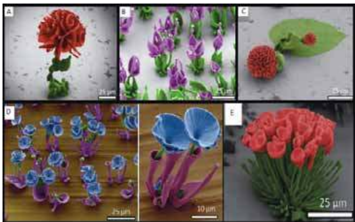
Rysunek 7: Sztucznie kolorowane obrazy SEM struktur, które możemy otrzymać używając opisanej metody. Widoczne struktury są efektem kolejnego osadzania w dwóch różnych rejonach wzrostu.
