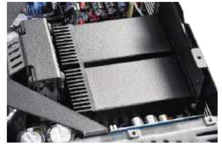
Moduły kart rozszerzeń są instalowane w dodatkowych, wewnętrznych komorach, mających także własne radiatory.
