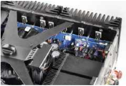
Podobnie jak w modelu Apex, w końcówce Diablo 333 zastosowano tranzystory Toshiba – dwanaście na kanał.
