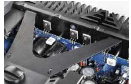
Obudowę wzmacnia wewnętrzna, górna rama spinająca boczne panele oraz stabilizująca transformator zasilający.
