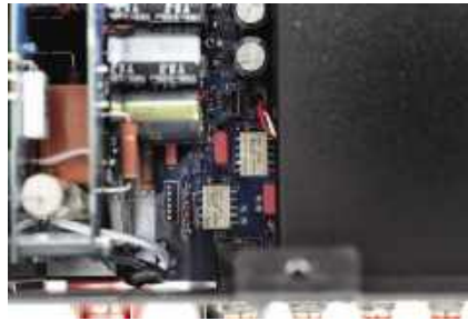
Wysokiej klasy przełączniki potrzebne są nie tylko do zmiany wejść, ale także w układzie regulacji głośności.
