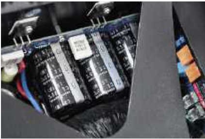
Część elementów filtrujących napięcie umieszczono na płytach końcówek mocy, część na dodatkowych modułach.
