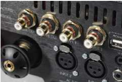
Gniazda RCA są bardzo solidne, z masywnymi kołnierzami i nakrętkami mocującymi do tylnej ścianki.
