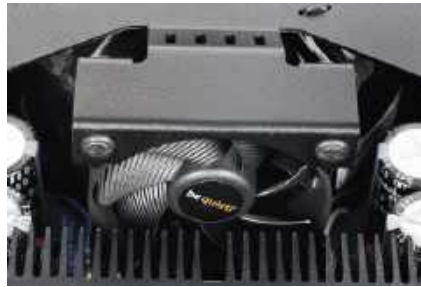
Odprowadzanie ciepła wymagało zastosowania wentylatora, który pracuje od razu po włączeniu zasilania.
