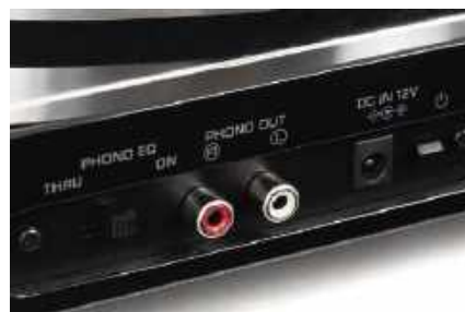
Zintegrowany układ korekcji (i wzmacnienia) phono włączamy tylko wtedy, gdy nie stosujemy takiego układu na zewnątrz.
