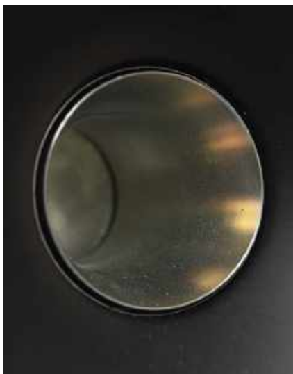
Duży falowód w IsoFlare Classiców X i XII prowadzi promieniowanie od przetwornika wysokotonowego zbudowanego na wzór przetworników kompresyjnych; jego 75-mm membrana jest znacznie większa od wlotu falowodu, zasłoniętego siateczką.
