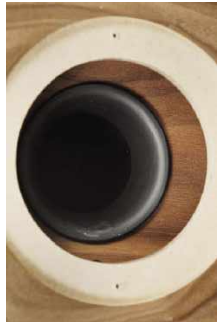
Obudowa VIII SM, jako jedyna wśród Classików, nie ma dodatkowej wewnętrznej komory – już w drugiej ścianie jest zainstalowany tunel (o średnicy ok. 7 cm i długości 16 cm).
