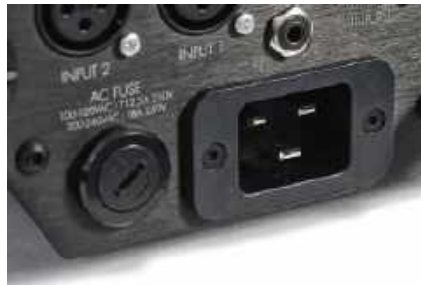
Gniazdo zasilające przygotowano w standardzie C20 (a więc 20-ampierowym); główny bezpiecznik jest 8-ampierowy.
