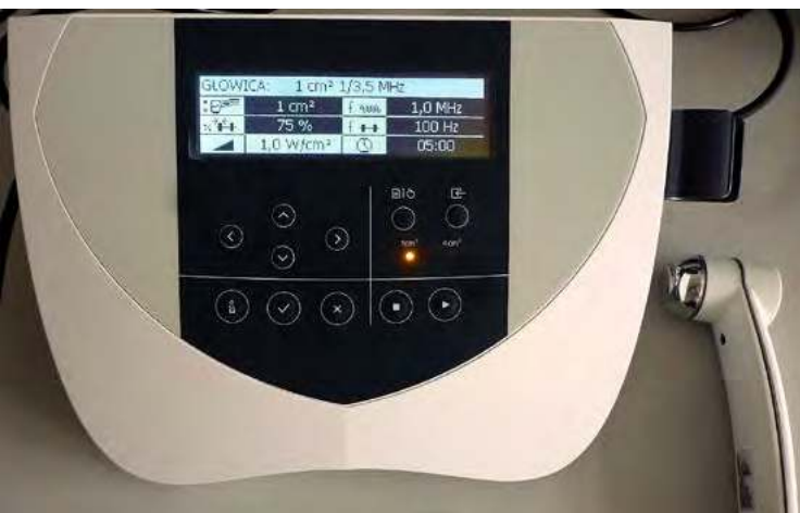
Fot. 1. Aparat do sonoterapii z głowicą emitującą ultradźwięki o częstotliwościach 1 i 3,5 MHz oraz natężeniach 0,5 – 2,5 W/cm 2 .
