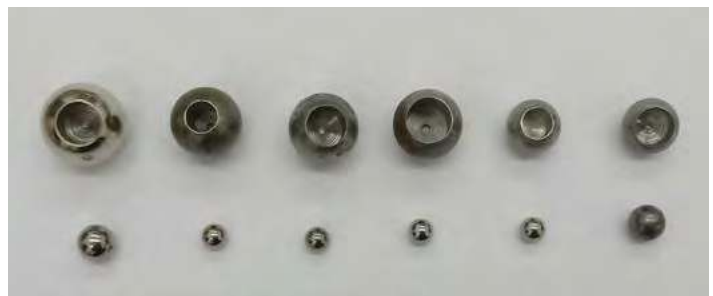
Fot. 2. Przykłady zestawów złożonych z większych kulek z wywierconym otworem i mniejszych kulek przeznaczone do badania zderzeń.
