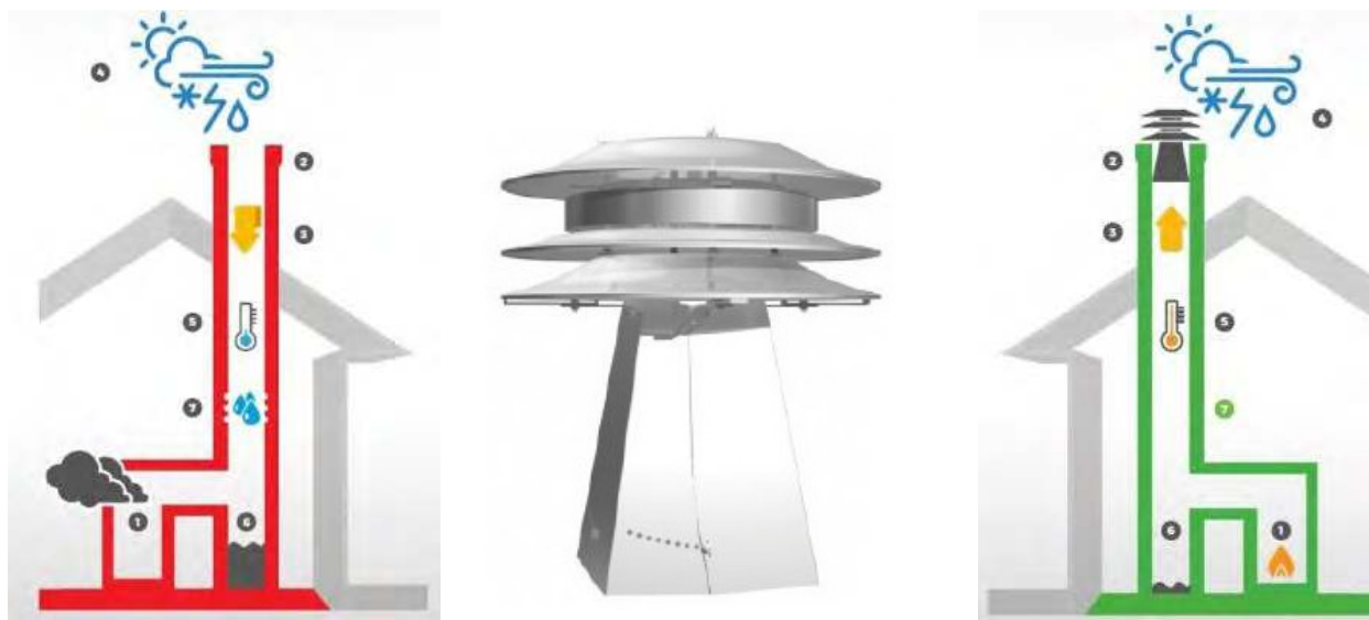
Rysunek 3. Regulator Ciągu Kominowego – system grzewczy bez regulatora: 1 – duże zużycie opału, 2 – duża emisja zanieczyszczeń do atmosfery, 3 – zawiewanie, czyli cofanie spalin, 4 – praca systemu zależna od warunków pogodowych, 5 – zimny komin uniemożliwiający prawidłową pracę systemu, 6 – znaczna ilość kondensatu, 7 – erozja komina spowodowana zawilgoceniem komina
