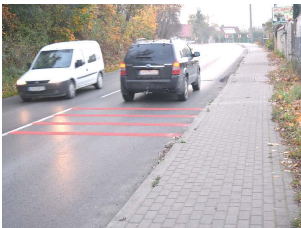
Czerwone linie wywołują w przejeżdżającym samochodzie wibracje. To ma uprzytomnić kierowcy, że zbliża się do ostrego zakrętu i lepiej zdjąć nogę z gazu. Takie linie ustawiono przed zakrętem z obu stron – od Kazimierza i od Puław
