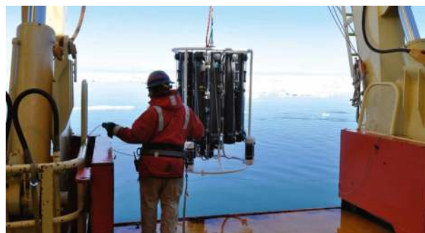
Naukowcy opuszczają do antarktycznego Morza Rossa przyrząd do pomiaru koncentracji żelaza na różnych głębokościach.
