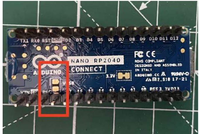
Fotografia 5. Lokalizacja zworki USB na płytce z RP2040
