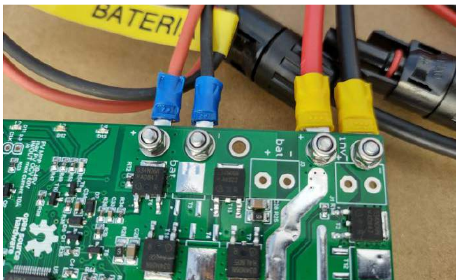
Fotografia 3. Połączenia przewodów wykonane przy użyciu końcówek oczkowych oraz śrubek M3 z nakrętkami samohamownymi
