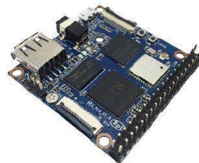
Fotografia 12. Komputer SBC typu Banana Pi M2 Magic
