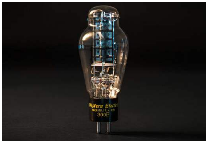
Fotografia 2. Lampa elektronowa mocy stosowana we wzmacniaczach audio
