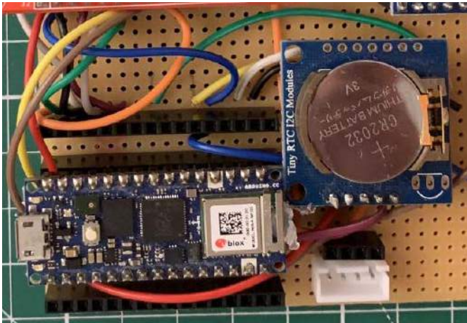
Fotografia 4. Moduł zegara RTC z baterią podtrzymującą
