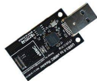
Fotografia 2. Programator do modułów z pamięcią eMMC
