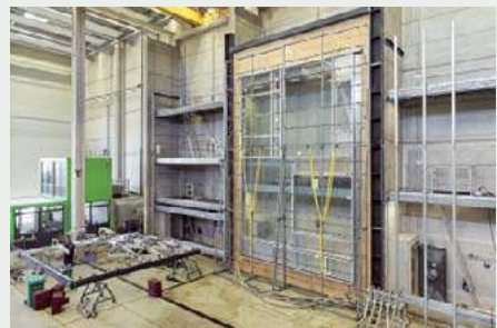
Testowana fasada Schüco AF UDC 80 o imponujących wymiarach 5,7 m x 8,8 m. Fot. Christian Eblenkamp
