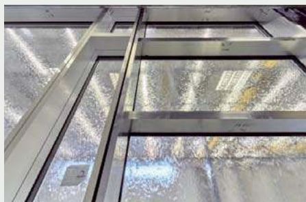
Fasada Schüco AF UDC 80 podczas badania wodoszczelności. Fot. Christian Eblenkamp
