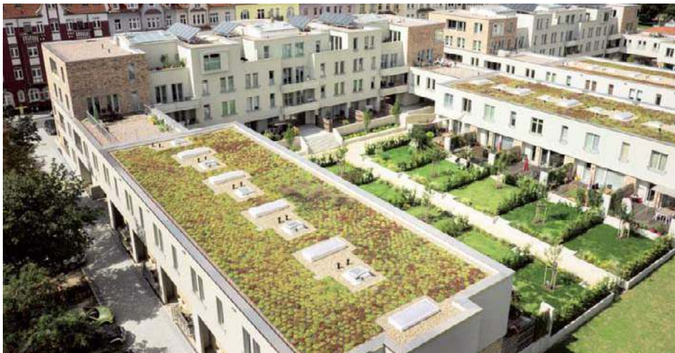
📌 Dachy zielone to nie tylko więcej roślinności. Potrafią one zatrzymać nawet ok. 50% wody opadowej. GALECO
