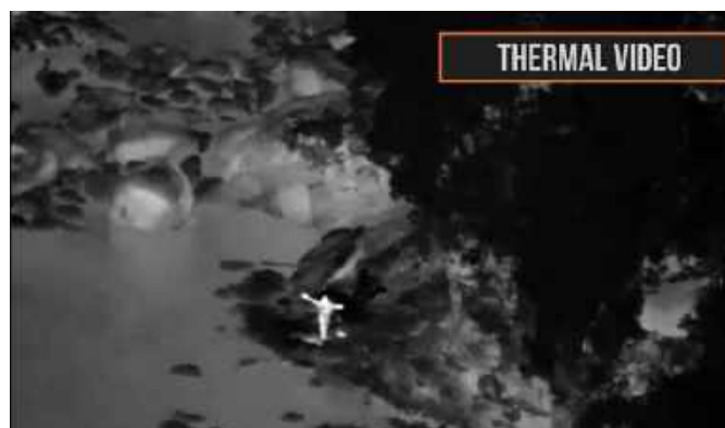
Fotografia 3. Zdjęcie z kamery termowizyjnej zamontowanej na śmigłowcu poszukiwawczym. Widoczna jest sylwetka człowieka, który zgubił się na szlaku (źródło: Trap and Trigger Ltd.)
