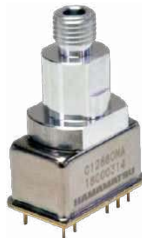
Fotografia 2. Moduł C12880MA w wersji ze złączem światłowodowym SMA
