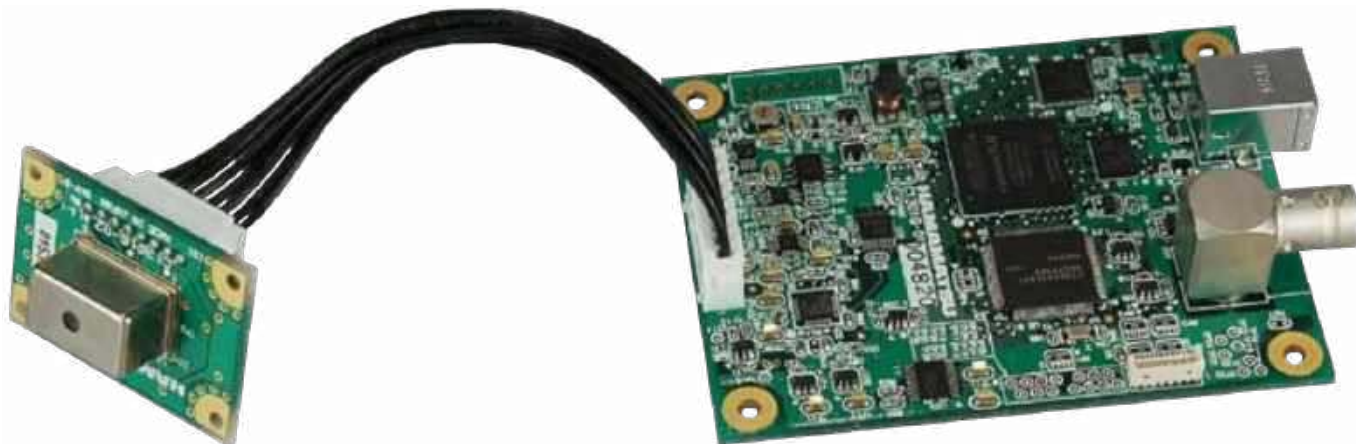
Fotografia 4. Zestaw ewaluacyjny z modułem spektrometru i kompatybilną kartą akwizycji danych, wyposażoną w port USB
