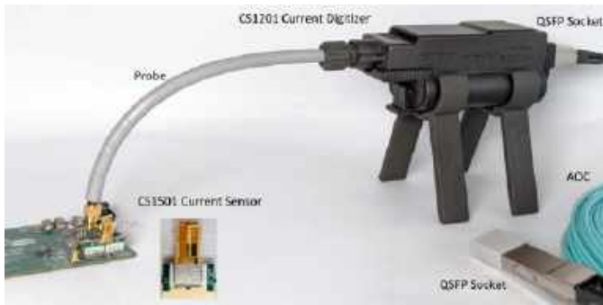
Fotografia 3. Digitizer prądowy CS1201 z izolacją do 30 kV
