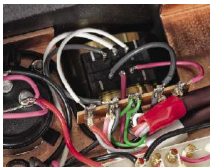
Sygnał do potencjometru głośności (ulokowanego z przodu) poprowadzono od tylnej ścianki srebrnym kablem.
