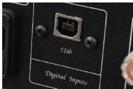
Wejście USB-DAC przyjmuje sygnały PCM 32/384 oraz DSD128.
