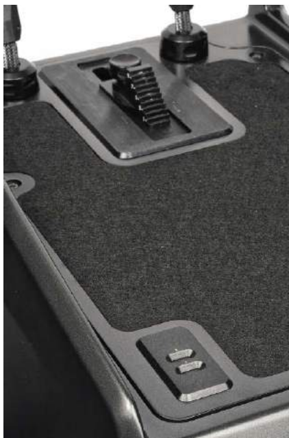
Z przodu górnej płyty modułu niskotonowego widać zagłębienia dwupozycyjnej regulacji wysunięcia modułu średnio-wysokotonowego. Większa część powierzchni została wyłożona materiałem tłumiącym.
