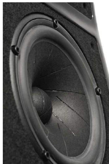
18-cm średniotonowy z nacinaną, celulozową membraną wygląda znajomo – to elementy popularnego Revelatora Scan-Speaka.
