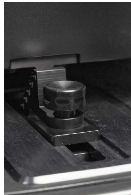
Dziesięć schodków pozwala na bardzo precyzyjną regulację pochylenia. Wybraną pozycję blokujemy śrubą.
