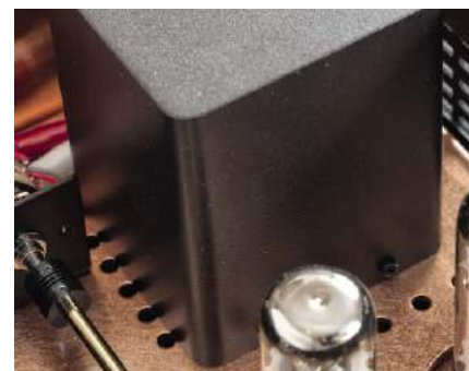
Każdy z transformatorów głośnikowych ma własną obudowę (zalaną wytłumieniem i pełniącą rolę ekranu).
