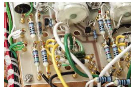
Płytki drukowane pełnią rolę podstawek montażowych, większość połączeń wykonano metodą punkt-punkt.
