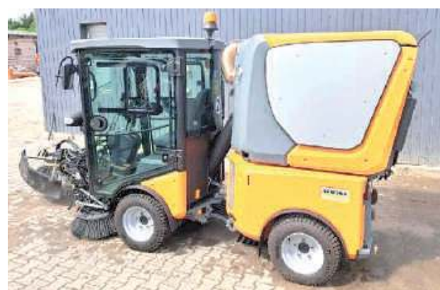
Pojazd jest wyposażony w zbiornik na wodę, dzięki czemu może być wykorzystywany nie tylko jako zamykarka do ulic, ale także posłużyć np. do mycia kostki czy ławek zanieczyszczonych przez ptaki
