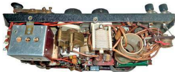
Wnętrze radiostacji AP-5 – widok spodu z boku
