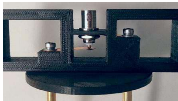
Fot. 3. Połączenie prętów z gniazdkiem BNC
