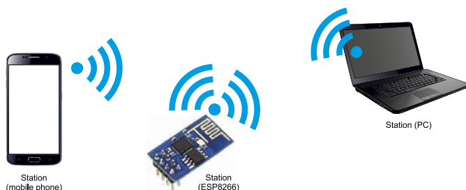
Rysunek 5. Schemat przykładowej aplikacji modułu Wi-Fi w trybie AP
