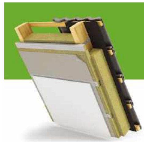
🔗 W metodzie lekkiej suchej zastosowanie ma tylko wełna mineralna. Wypełnia się nią drewniany lub stalowy ruszt konstrukcyjny przymocowany do ściany, a następnie osłania ocieplenie wiatroizolacją i okładziną elewacyjną. EKODREWNO
