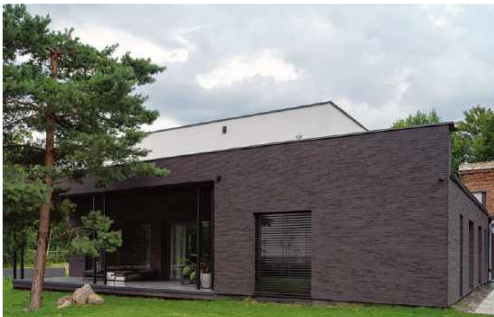
🔗 Okładzina z elastycznego klinkieru zastosowana na dużej powierzchni staje się jednym z głównych elementów wykończenia elewacji. Jej kolor i faktura mocno wpływają na odbiór całej bryły, dlatego przy takim zastosowaniu szczególnego znaczenia nabiera dobór odcienia i formatu płytek. ELASTYCZNY KLINKIER / ELASTOLITH
