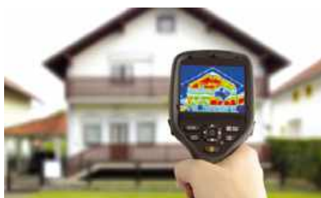
🔍 Audyt energetyczny wraz z badaniem termowizyjnym pozwalają precyzyjnie ustalić, które elementy domu wymagają ocieplenia. ISOVER
