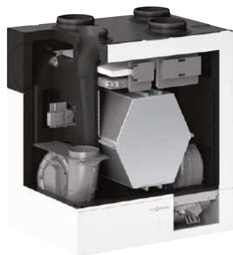
Najważniejszym elementem centrali wentylacyjnej jest wymiennik ciepła. Dzięki niemu świeże powietrze doprowadzane do domu ogrzewa się ciepłem pochodzącym ze zużytego powietrza usuwanego na zewnątrz. VIESSMANN
