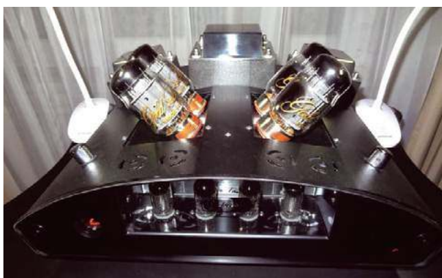
Wzmacniacz z lampowym silnikiem w układzie V. Egg-Shell TANQ. Dwie KT88 na kanał, Single Ended, 2 x 20 W.
