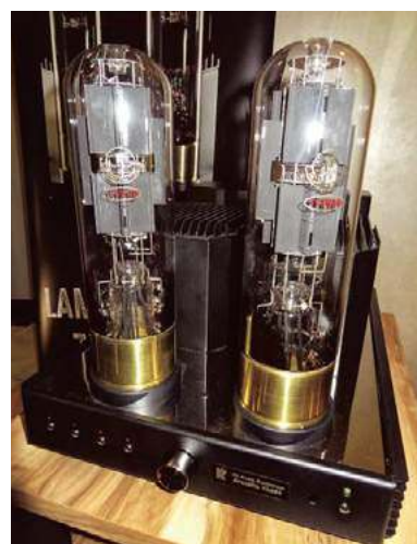
„Największe na świecie” triody T-1610 firmy KR Audio Electronics – we wzmacniaczu Kronzilla VA680.
