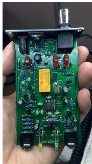
Konstrukcja transceivera D4D na płycie drukowanej
