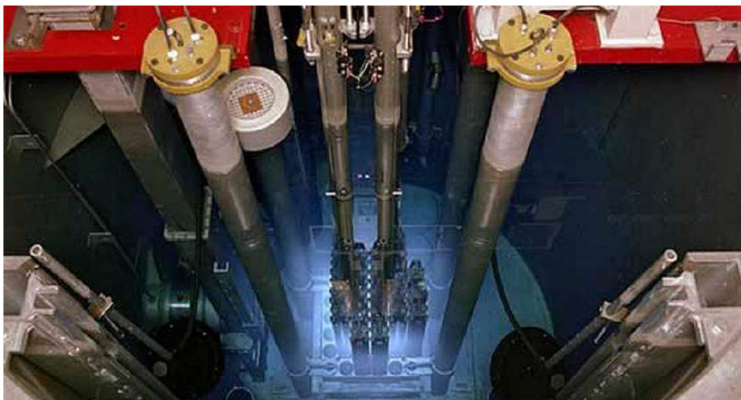
7. Główne zastosowanie uranu to energetyka jądrowa. Na zdjęciu wnętrze reaktora z widocznymi pętlami paliwowymi
