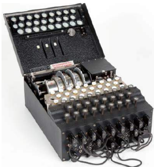
3. Enigma – niemiecka przenośna elektromechaniczna maszyna szyfrująca, źródło: https://shorturl.at/biyHM
