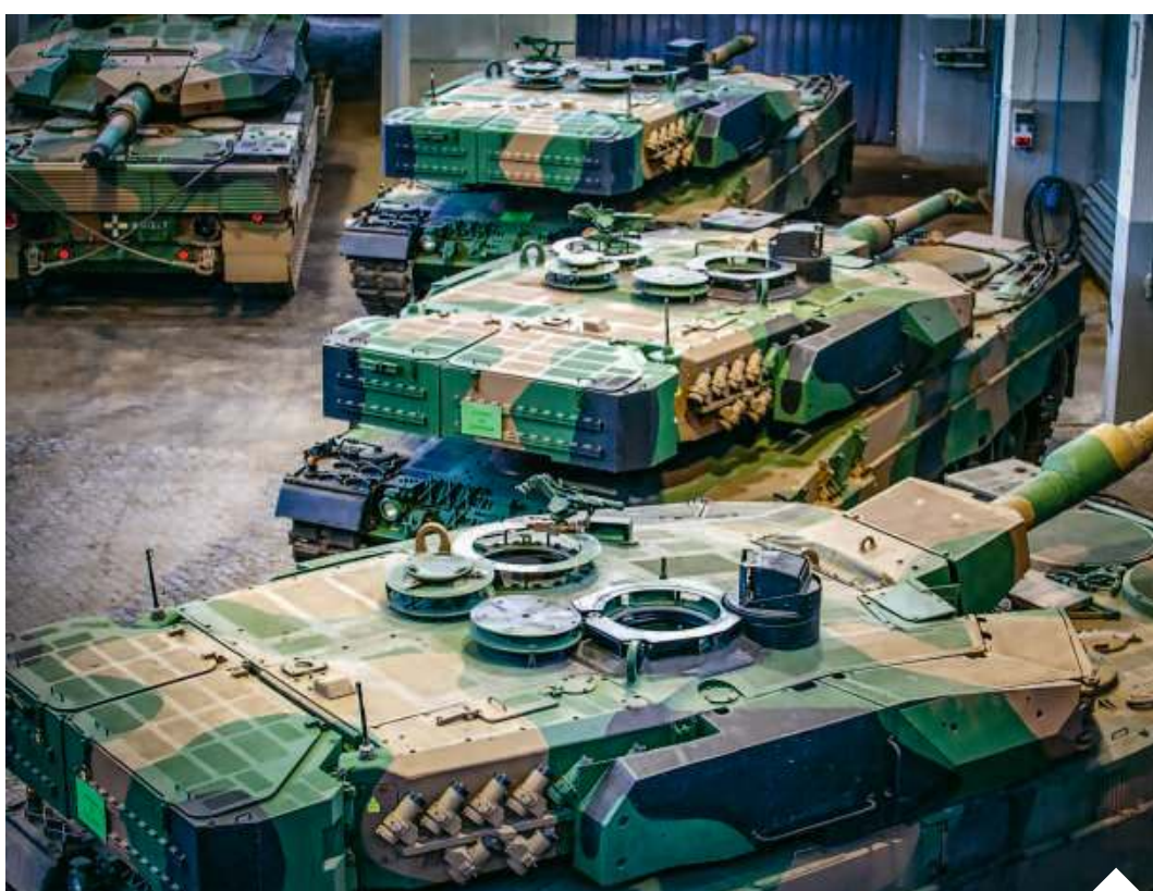
Wersja 2PL różni się od poprzednich wozów przede wszystkim pod względem przyrządów obserwacyjnych | fot. Wikipedia/d
