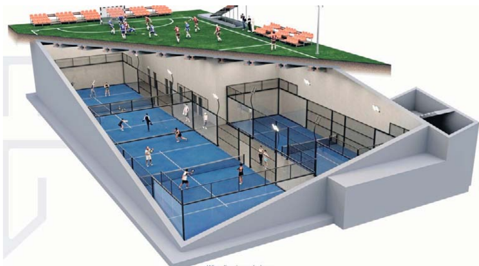
ORLIK S-1 to schron kategorii S-1 dla 750 osób zaprojektowany pod standardowym boiskiem szkolnym o wymiarach 20x40 metrów.
