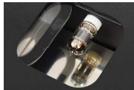
Na wyjściu analogowym pracuje podwójna trioda ECC82, w tym przypadku element Electro Harmonix.
