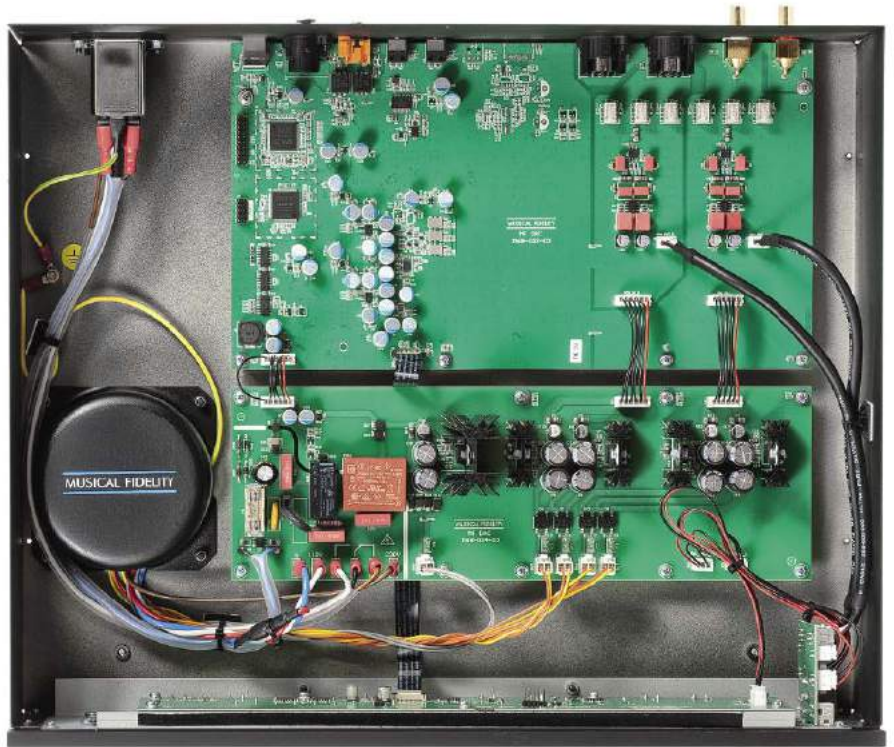
Transformator jest wspólny dla obydwu kanałów, ale już na płytce z układami zasilania następuje rozdzielanie zgodne z deklaracją dual-mono.
