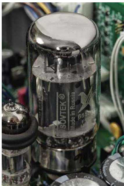
Lampy 6550 stosowane są zazwyczaj w końcówkach mocy, Audio Research wykorzystuje taką w zasilaczu 6SE; do zasilacza trafiła też jedna 6H30.
