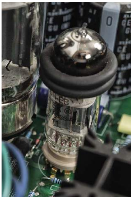
Na lampach 6H30 założono pierścienie tłumiące drgania
