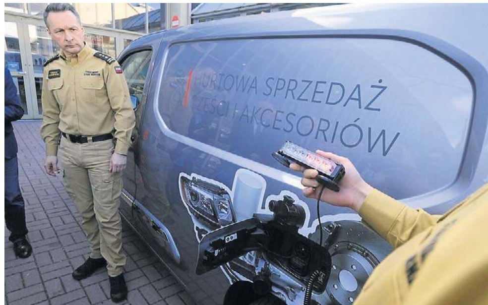
Po podłączeniu wtyczki do portu ładowania samochód zostaje unieruchomiony
