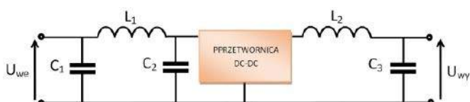
Rysunek 9. Układ redukcji zakłóceń w przetwornicy DC-DC
