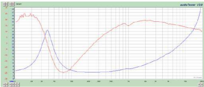
Rysunek 8. Charakterystyka modułu impedancji w funkcji częstotliwości (kolor niebieski) oraz charakterystyka fazowo-częstotliwościowa (kolor czerwony) głośnika typu SB Acoustics SB20PFCR30-4 zmierzona na wolnym powietrzu
