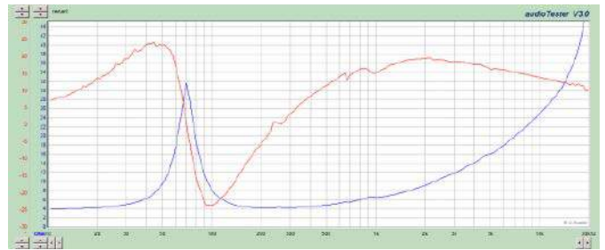
Rysunek 9. Charakterystyka modułu impedancji w funkcji częstotliwości (kolor niebieski) oraz charakterystyka fazowo-częstotliwościowa (kolor czerwony) głośnika typu SB Acoustics SB20PFCR30-4 zmierzona w obudowie zamkniętej
