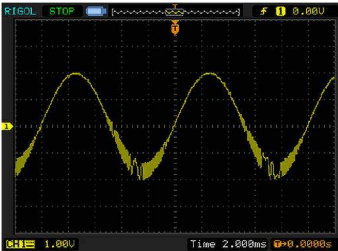
Rysunek 10. Zjawisko wzbudzenia się układu na częstotliwości ok. 1 MHz, któremu zapobiega zastosowanie cewki L1 na wyjściu wzmacniacza mocy
