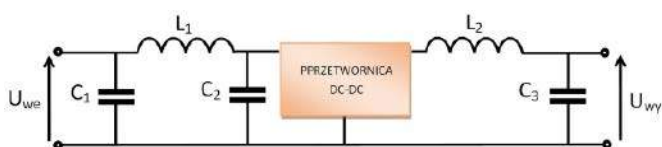
Rysunek 9. Układ redukcji zakłóceń w przetwornicy DC-DC
