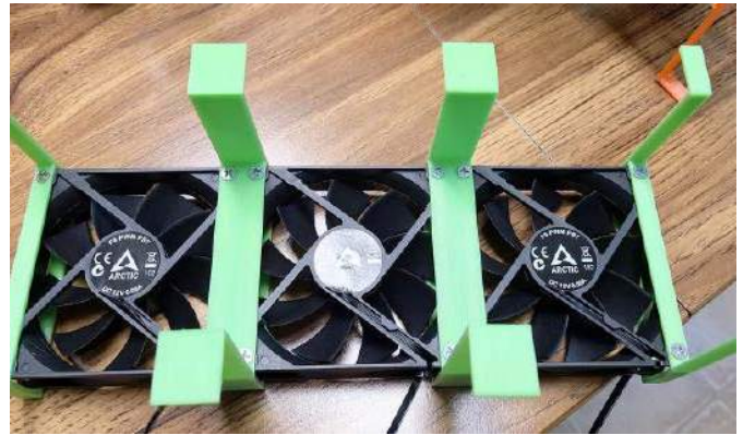
Fotografia 2. Plastikowe uchwyty wentylatorów z drukarki 3D, zamontowane na trzech wentylatorach 92 mm
