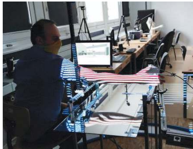
Proces skanowania 3D światłem strukturalnym na specjalnym stanowisku systemu AutoMedPrint (czeka na patent).
