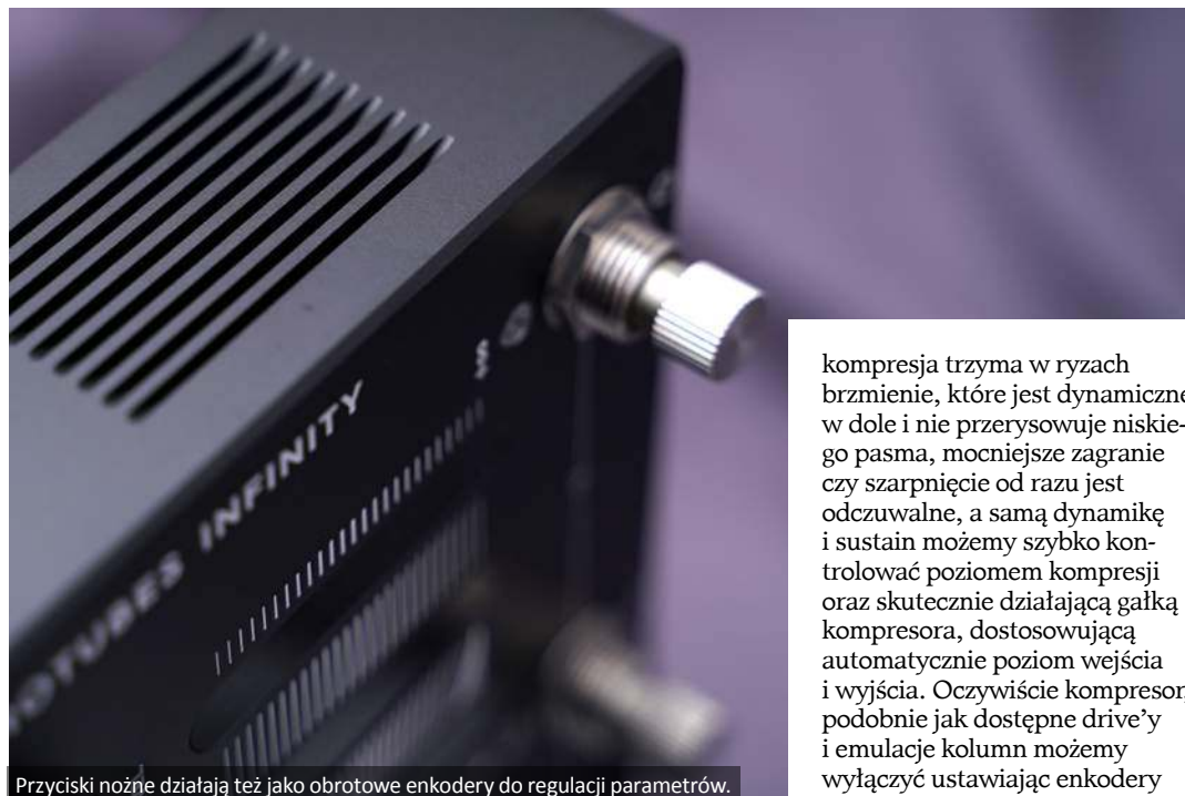
Przyciski nożne działają też jako obrotowe enkodery do regulacji parametrów.
